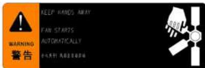
保持手、衣物和工具等远离运转的冷却风扇叶片。冷却风扇电机有时即使在车辆不运行时也工作。在冷却风扇叶片附近作业时保持高度谨慎，避免转动的风扇叶片伤害您。
