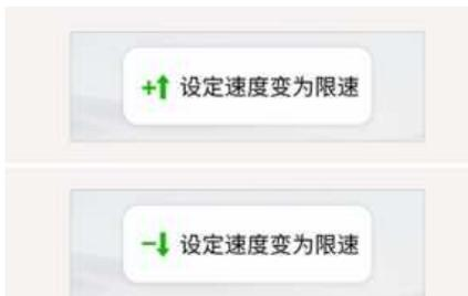
在手动限速辅助 (MSLA) 功能或智能巡航辅助 (SCC) 功能控制期间，当公路设置限速发生改变时，就会以显示向上或向下箭头符号的方式告知驾驶员需要变更车辆设定速度。此时，驾驶员可以操作方向盘上的增速 (+) 或降速 (-) 开关，将车辆设定速度变更至与公路设置限速一致。在下列条件下，执行变更设定速度操作：
