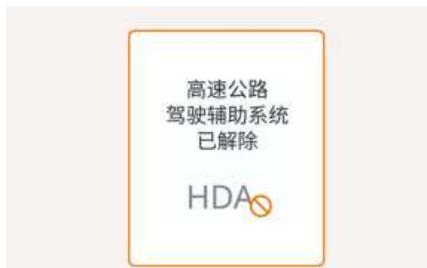
在未握方向盘警告功能发出警报后，如果驾驶员仍然没有握住方向盘，将会显示“**高速公路驾驶辅助系统已解除**”的警告信息，并自动关闭高速公路驾驶辅助(HDA)功能和高速公路变道辅助功能。
