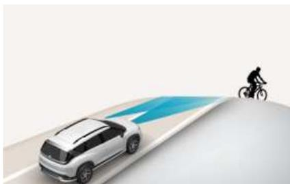
在上坡或下坡道路上行驶时，会严重影响前向防撞辅助 (FCA) 传感器的检测性能，前向防撞辅助 (FCA) 功能可能检测不到前方的车辆、动力两轮车、行人或骑行者。
