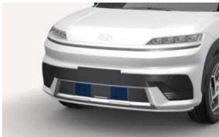
主动风门 (AAF) 系统通过操作前保险杠下方的风门打开或关闭，控制车辆部件的冷却，以便提高能量效率。
