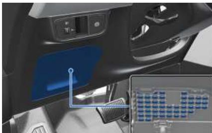
4. 直接拔出可疑保险丝。使用动力电部件舱保险丝盒内提供的保险丝拔具。
