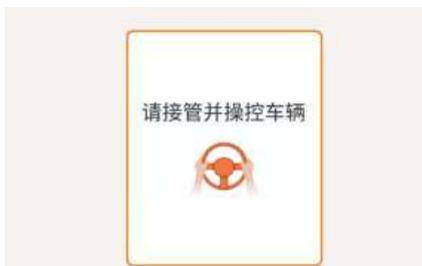
如果紧急制动警告功能持续未响应, 系统将自动启用转向控制与减速控制, 辅助车辆在车道内安全停车。紧急制动功能启动控制时, 系统将通过警告信息、警报声、紧急灯光闪烁及方向盘振动进行多级预警。
