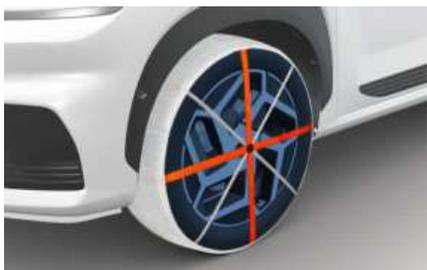
由于子午线轮胎侧围比其它类型的轮胎薄，如果在其上装配某些类型的防滑链，可能会损坏轮胎。因此，请使用推荐的雪地轮胎代替防滑链。请勿在配备铝制轮毂的车辆上安装轮胎防滑链，轮胎防滑链可能导致轮毂损坏。安装轮胎防滑链时，仔细阅读随轮胎防滑链提供的使用说明。由于轮胎防滑链使用不当而导致的车辆损坏事件，不在新车有限保修范围内。
