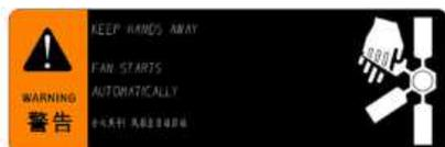
在使用V2L功能时，即使车辆电源按钮在OFF位置，动力电部件舱内的冷却风扇也可能会自动运转。因此，在使用V2L功能时，禁止手或松散衣服等靠近冷却风扇叶片。
