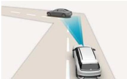
在弯道上行驶时，智能巡航辅助 (SCC) 功能可能检测不到在相同车道内的前方车辆，这可能会使车辆加速到设定的巡航辅助速度。此外，当突然检测到前方车辆时，车辆可能会紧急减速。
