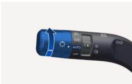
2. 将灯光开关向电子眼视觉 (前视系统) 功能方向推动。仪表盘控件上的远光灯辅助指示灯 (👁) 亮, 并启动远光灯辅助 (HBA) 功能。
