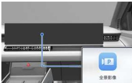
车辆电源在ON位置时，可以设置全景影像监测功能(CP)按钮。在信息娱乐系统设置菜单中选择应用程序) > 全景影像监测(SVM)项，可以如下进行设置或变更。
