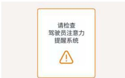
注视前方警告(FAW)系统不能正常运行时，就会在仪表盘显示器上显示“**请检查注视前方警告系统**”的警告信息几秒钟，并且仪表盘控件上的注视前方警告灯(👁️)亮，同时发出警报声，直至注视前方警告(FAW)功能正常运行。在此状态下，我们建议您将此系统有关的所有检查、维修和更换工作交由北京现代授权经销商进行。
