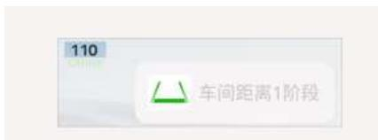
在智能巡航辅助(SCC)功能控制期间，如要临时加速而不改变设定速度，可以踩下加速踏板加速。当踩下加速踏板时，仪表盘控件上的巡航辅助设定速度、设定车距等级和目标车距将会闪烁。
