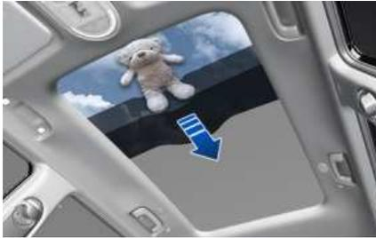
如果在电动遮光板或天窗玻璃自动关闭期间检测到障碍物的阻力，电动遮光板或天窗玻璃自动反向操作，然后停止移动。
