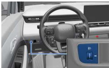
要根据车辆乘员数及行李箱内的装载重量调整大灯光束水平角度，操作大灯水平调整开关至适当等级。
