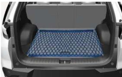
为了防止行李箱内物品移动，您可以使用行李箱侧装饰板内的6个固定钩固定行李网，罩住物品。
