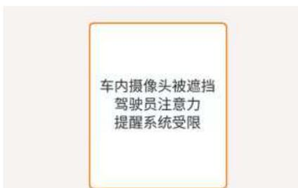
当车内摄像头前方或驾驶员与摄像头之间有物品遮挡时，注视前方警告(FAW)功能不能正常运行。如果发生此类情况，就会在仪表盘显示器上显示“**车内摄像头被遮挡，注视前方警告系统受限**”的警告信息几秒钟，并且仪表盘控件上的注视前方警告灯(👁️)亮，同时发出警报声，直至注视前方警告(FAW)功能正常运行。
