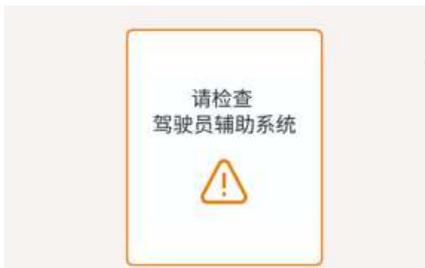
泊车距离警告 (PDW) 系统或其它有关系统不能正常运行时, 就会在仪表盘上显示“**请检查驾驶员辅助系统**”的警告信息。在此状态下, 我们建议您将此系统有关的所有检查、维修和更换工作交由北京现代授权经销商进行。
