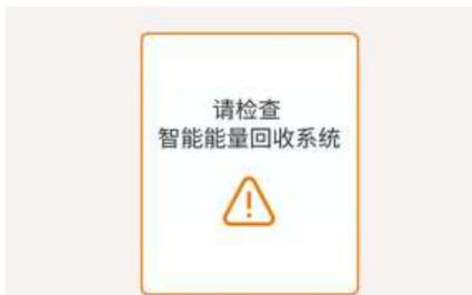
如果因前雷达传感器被异物遮挡或其他原因导致智能再生系统关闭，则会显示“**检查智能再生系统**”的警告信息。仪表盘上的再生制动强度等级指示灯自动控制（AUTO）切换至等级显示。
