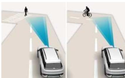
在弯道上行驶时，会严重影响前向防撞辅助 (FCA) 传感器的检测性能，前向防撞辅助 (FCA) 功能可能检测不到弯道上前方的车辆、动力两轮车、行人或骑行者。这可能导致在必要时不发出碰撞危险预警、不采取紧急制动辅助控制。
