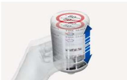
2. 拆下密封胶瓶盖并打开密封胶瓶座盖,将密封胶瓶口拧到密封胶瓶座上。
