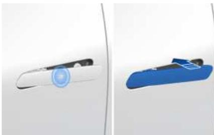
当所有车门关闭状态下，携带智能钥匙触摸驾驶位车门外侧手柄上的触摸传感器（雕刻部分）时，闭锁所有车门。
