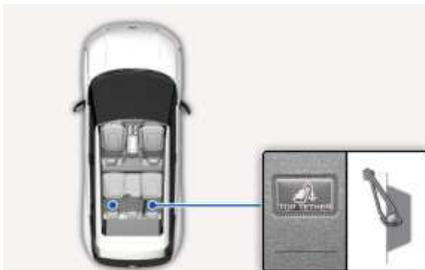
首先使用 ISOFIX 固定锚或安全带带固定儿童保护座椅 (CRS)。如果儿童保护座椅制造商建议使用顶部拴带，将顶部拴带系在顶部拴带固定锚上。
