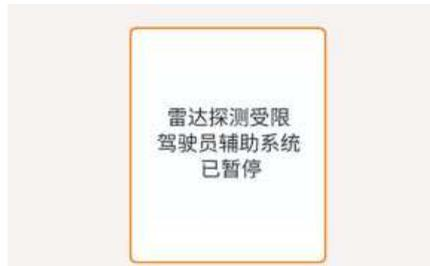
如果前挡风玻璃的前视摄像头安装部位、前雷达传感器盖或传感器被积雪、雨水等异物遮挡，会降低检测传感器的检测性能，这会导致正面防撞辅助 (FCA) 功能暂停或关闭。
