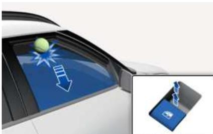
如果门窗在自动关闭期间检测到障碍物的阻力, 门窗会停止移动, 并自动下降约 30cm, 以便清除障碍物。
