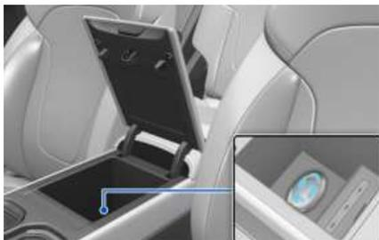
1. 如果车辆因智能钥匙电池耗尽或无线电干扰而无法启动, 请将智能钥匙置于中央控制台储物箱内的紧急启动符号位置。(如果制动开关保险丝熔断, 请在 OFF 模式下踩下制动踏板, 同时按下启动 / 停止按钮 10 秒钟。)
