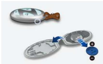
2. 拆卸旧电池，并插入新电池。确认电池极性方向正确。如果智能钥匙电池安装位置不当，就会造成电池无谓放电，导致智能钥匙故障。
