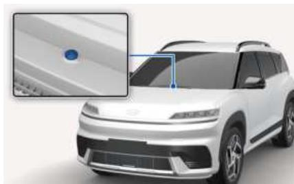
禁止在光照度传感器上方和附近加装任何附件，以确保暖风&空调控制系统的最佳性能。
