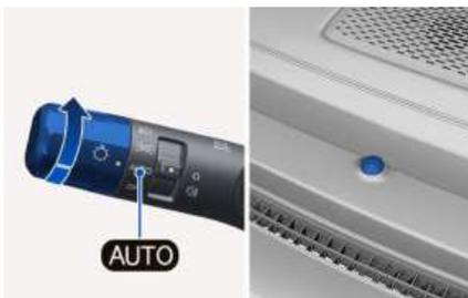
利用位于挡风玻璃上端的自动灯光传感器检测的环境亮度信息，自动控制打开和关闭驻车灯/尾灯、大灯。
