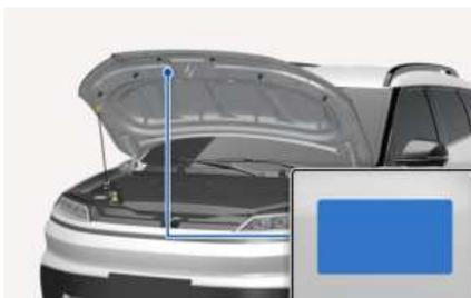
您能从附着在机舱盖内板上的标签上找到您车辆应用的空调制冷剂规格和容量。
