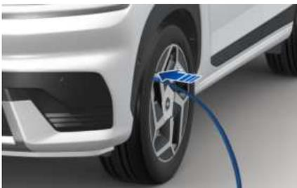
12. 将压缩机电源插头牢固插入在车辆电源插座上。
