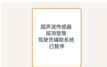
在下列条件下，就会在仪表盘显示器上显示“**摄像头视野受限，驾驶员辅助系统已暂停**”或“**超声波传感器探测受限，驾驶员辅助系统已暂停**”的警告信息：
