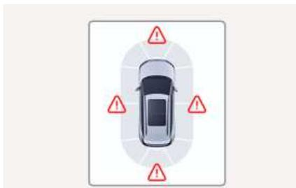
在泊车距离警告 (PDW) 功能控制时, 如果此功能不能正常运行, 或者超声波传感器被遮挡, 就会在仪表盘上对应传感器方向上显示主 (Δ) 警告灯亮。您可以在仪表盘上的实用视图模式中查看警告信息。
