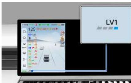
所选的再生制动等级会显示在仪表盘控件上。当车辆在再生制动等级降至0后，关闭车辆电源并重新新启动时，再生制动等级变为1。
