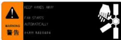
充电期间，禁止手或松散衣服等靠近冷却风扇叶片。即使车辆关闭，它也可以自动运行以控制蓄电池温度。
