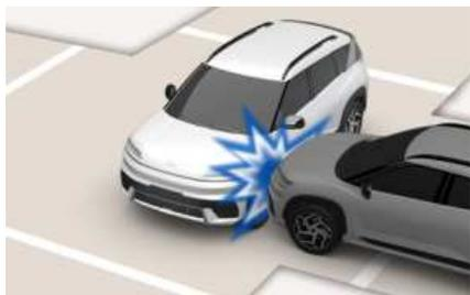
正面气囊设计为在车辆侧面碰撞中不展开。因为在车辆侧面发生碰撞时，由于撞击惯性力的作用，乘员的身体会向碰撞方向移动。
