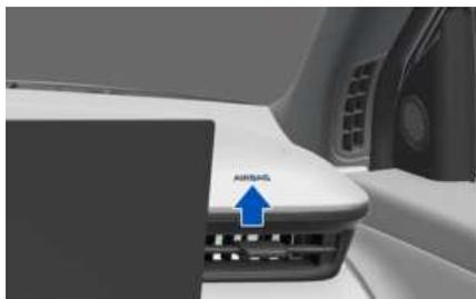
辅助保护系统(SRS)包括安装在方向盘中央的驾驶席正面气囊、安装在副驾驶前手套箱上方仪表板内侧的副驾驶正面气囊。
