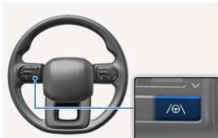
启动/停止按钮在ON位置时，按下车道跟踪辅助 (LFA) (⊕/⊖) 按钮。车道跟踪辅助 (LFA) 功能启动时，仪表盘上的⊕指示灯会显示为灰色或绿色。要关闭车道跟踪辅助 (LFA) 功能时，再次按住车道跟踪辅助 (LFA) 按钮。
