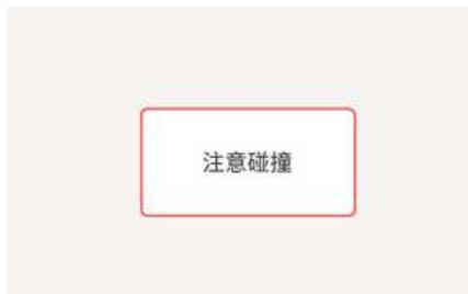
当智能巡航辅助功能运行期间存在与前方车辆发生碰撞的高风险时，前向防撞辅助功能将自动激活并向您发出碰撞预警。请立即确认前方道路及行驶状态，必要时请直接踩下制动踏板以调节车速。
