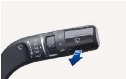
向后拉动雨刮器&喷水器控制杆，喷水器启动向挡风玻璃喷射清洗液，同时雨刮器运转1-3周。当雨刮器&喷水器控制杆保持在此位置时，喷水器和雨刮器持续工作，直至释放雨刮器&喷水器控制杆。如果喷水器不工作，可能是挡风玻璃清洗液箱空所致，需要加注挡风玻璃清洗液。
