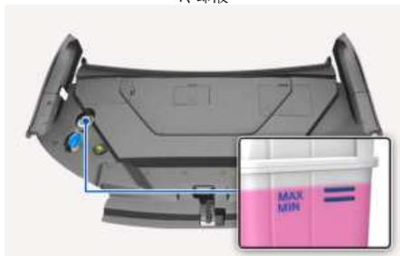
低电导率冷却液
