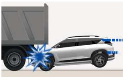
在发生碰撞的一刹那，驾驶员通常会采取紧急制动措施。这种紧急制动有效降低车辆的前部高度，导致车辆的前部“钻撞”。这在前方车辆离地间隙较高时尤其重要。如果车辆处于“钻撞”状态，气囊不
