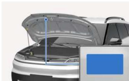
在制冷剂标签上标有制冷剂型号和制冷剂容量信息。
