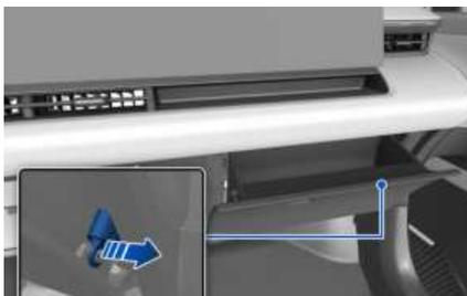
2. 如上图所示，将手套箱的两侧向内侧推动，使手套箱止动销从其固定位置脱开，并将手套箱放下处于悬垂状态。
