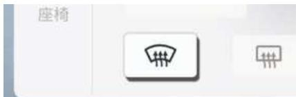
触控前挡风玻璃除霜按钮(指示灯亮)时,前挡风玻璃除霜功能启动。如果设置挡风玻璃除雾模式,根据检测的车外温度,自动选择“空气外循环(新鲜空气)”模式,并且自动启动运行制冷系统。
