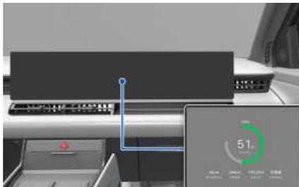
车辆电源关闭时，请在信息娱乐系统显示器上查看充电状态，以监控动力蓄电池电量及预计充电时间。
