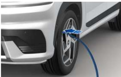
3. 将压缩机电源插头牢固插入在车辆电源插座上。
