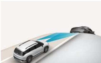
在上坡 / 下坡道路上行驶时，智能巡航辅助 (SCC) 功能可能检测不到本车道内的前方车辆，这可能会使本车辆加速到设定的巡航辅助速度。此外，如果突然检测到前方车辆，车辆可能会紧急减速。
