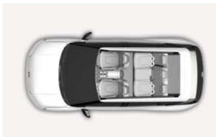
在后座椅的左侧/右侧座位上配备了ISOFIX固定锚。它们的位置如图所示。在后中央座位上没有提供ISOFIX固定锚。
