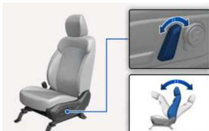
向前/向后拨动控制开关，调整座椅靠背角度。
