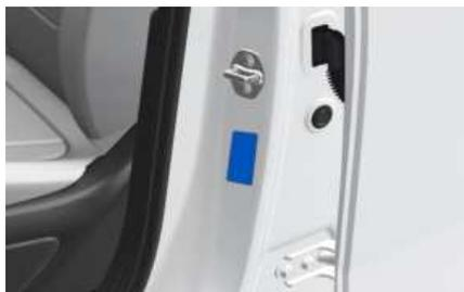
在驾驶位侧中央立柱上的轮胎标签上可以查到轮胎所有规格 (轮胎尺寸、气压等)。
