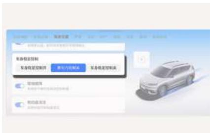
电子稳定控制 (ESC) 功能在车辆转弯过程中帮助稳定车辆。
