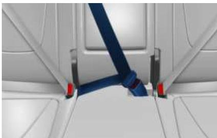
将金属卡扣插入至扣环中，直至听到“咔嚓”声，表示卡扣正确锁入在扣环内。拉动安全带束带的肩带部分，使安全带束带舒适绕过您的胯部，并消除松弛部分。确认安全带束带没有扭结。
