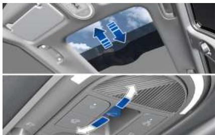
使用电动遮光板阻挡通过天窗玻璃直射的阳光。
