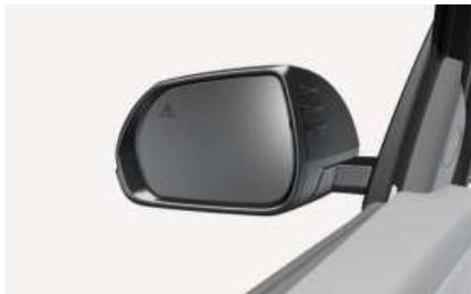
本车辆配备了左侧和右侧外后视镜。可以利用后视镜调整开关远程调整后视镜的位置。请在驾车起步之前，调整好外后视镜位置至理想位置。可以折叠外后视镜，以防在进入自动洗车机或驶过狭窄的道路时车辆损坏。
