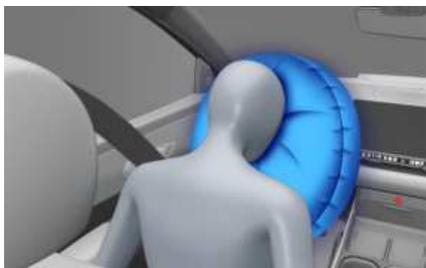
当辅助保护系统控制模块 (SRSCM) 检测到车辆正面碰撞严重性达到一定程度时, 自动展开正面气囊。
