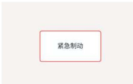
在仪表盘显示器上的前方安全警告灯(🚨)闪烁，并且显示“**紧急制动**”的警告信息，同时发出警报声和方向盘振动，向驾驶员发出即将采取紧急制动辅助控制的警报。
