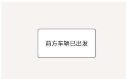
当检测到的前方停止的车辆驶离时，前方车辆出发提示功能就会在仪表盘显示器上显示“前方车辆已出发”的提示信息，同时发出警报声，以提醒驾驶员。
