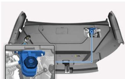
定期检查储油罐内的制动油量。制动油量应在储油罐侧面的“上限(MAX)”与“下限(MIN)”标记之间。
