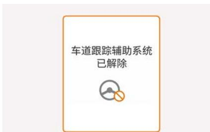
如果持续未握方向盘，系统将在发出警告音和车道保持辅助功能解除警告后，自动关闭车道跟踪辅助功能。
