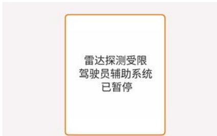
如果前雷达盖或传感器表面附着雪、雨等异物，可能导致识别性能下降，智能巡航辅助功能将暂时无法运行。仪表盘将显示警告信息 (一段时间后自动消失)，但这并非表示智能巡航辅助功能故障。清除异物后，智能巡航辅助功能将恢复正常运行。始终保持检测传感器清洁。
