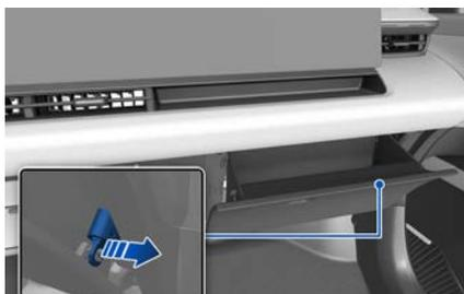
2. 如上图所示，将手套箱的两侧向内推动，使手套箱止动销从其固定位置脱开，并将手套箱放下处于悬垂状态。
