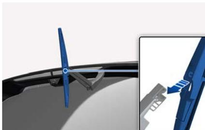
5. 将雨刮器臂轻轻地放回至后窗玻璃上。然后，将车辆电源转至 ON 位置，并操作雨刮器检查雨刮器片安装是否正确。
