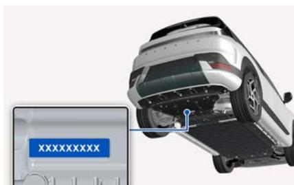
可以在车辆底部检查电机编号。
