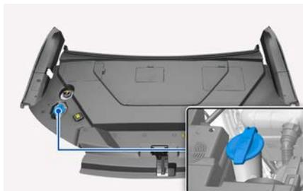
检查挡风玻璃清洗液箱内的清洗液量，按需要进行补充。如果没有标准的挡风玻璃清洗液，亦可使用普通水。但是，在寒冷季节，必须使用有防冻性能的挡风玻璃清洗液，以防清洗液冻结。
