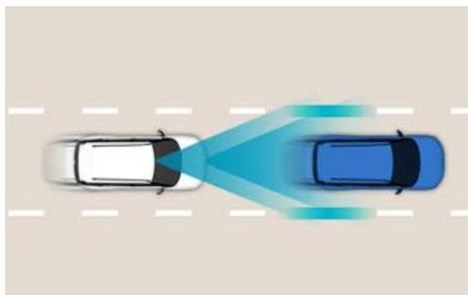
高速公路驾驶辅助(HDA)功能设计的目的是,在高速公路主干道上行驶时,辅助驾驶员控制车辆保持设定的与前方车辆之间的车距和以设定速度恒速行驶,并控制车辆保持在本车道中央行驶。
