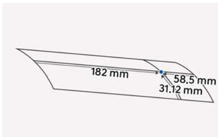
上面显示的座椅靠背角度 $19^{\circ}$ 与座椅位置182 mm是北京现代汽车提供的指定位置。座椅位置是座椅从最前位置向后移动182 mm的位置。
