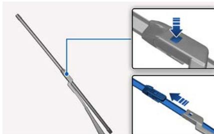
4. 安装新雨刮器片时，将其置于雨刮臂槽内，向内按压直至听到“咔嗒”声，即表示安装到位。
