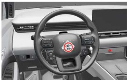
从密封胶瓶上撕下限速标签,并将限速标签粘贴在车内方向盘等显而易见的位置,以便时时提醒驾驶员遵守限速规定。
