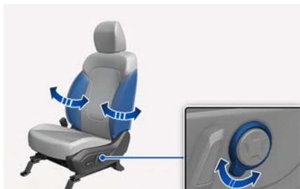
顺时针转动调整旋钮，座椅靠背侧翼向内侧合拢。逆时针转动调整旋钮，座椅靠背侧翼向外侧合拢。
