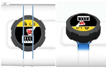
2. 确定冷却液箱盖内的微小凸起稳固互锁。
