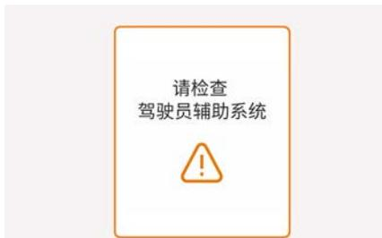
如果紧急制动 (ES) 功能出现故障, 仪表盘将显示警告信息 (一段时间后自动消失), 同时主 (△) 警告灯亮。在仪表盘显示界面期间, 可通过“实用信息视图”的服务消息来查看警告目标功能。请联系北京现代授权服务中心或服务站。
