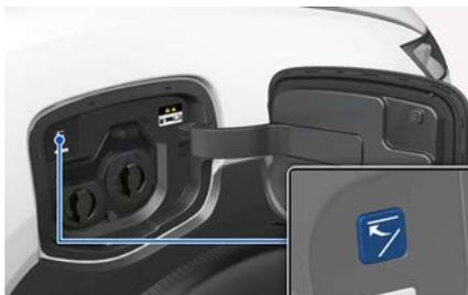
设置预约充电后，连接慢速充电器或便携式充电器 (ICCB) 时不会立即开始充电。如需立即为车辆充电，请选择屏幕上的 **应用程序** > **电动汽车** > **预约充电** 功能并关闭预约充电设置，或长按充电口内侧的关闭按钮 (🔌) 约3秒，即可将预约充电模式切换为立即充电模式。
