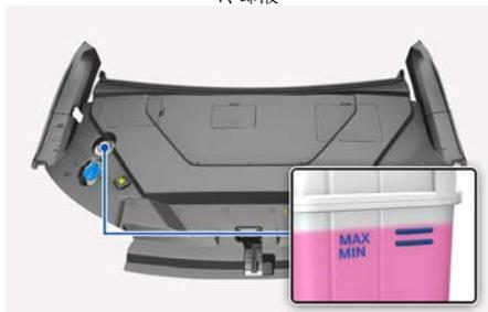
低电导率冷却液
