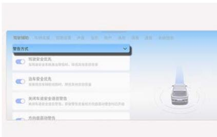
车辆电源在ON位置时,可以设置警告方式。在信息娱乐系统设置菜单中选择“**88 (应用程序)>设置>驾驶辅助>警告方式**”项,可以如下进行设置或变更。
