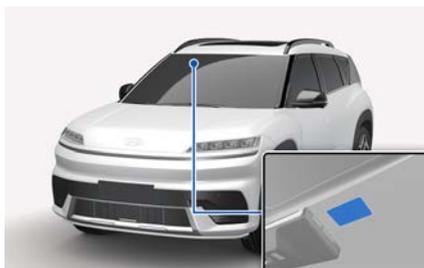
电子标识 (RFID) 标签应粘贴在车辆挡风玻璃内侧的推荐位置。请确保粘贴的位置不妨碍驾驶员的视线。
