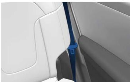
4. 拉起座椅靠背折叠调整杆，并向车前方向折叠座椅靠背。
