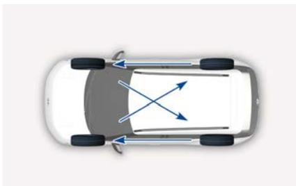
每次进行轮胎换位时，均应检查盘式制动器制动块的磨损情况。
