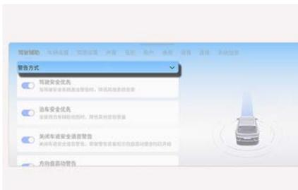
车辆电源在ON位置时，可以设置警告方式。在信息娱乐系统设置菜单中选择“**应用程序 > 设置 > 驾驶员辅助 > 警告方式**”项，可以如下进行设置或变更：
