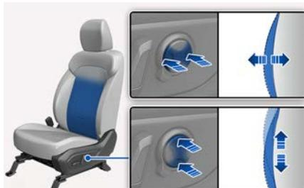
按下调整开关的前部，座椅腰垫突出；按下调整开关的后部，座椅腰垫缩进。
