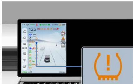
轮胎气压监测系统 (TPMS) 故障警告灯 (!) 在轮胎气压监测系统 (TPMS) 存在故障时闪烁约1分钟后保持亮。
