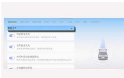
车辆电源在ON位置时,可以设置警告方式。在信息娱乐系统设置菜单中选择“**应用程序**”>**设置**>**驾驶辅助**>**警告方式**”项,可以如下进行设置或变更。
