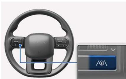
起动/停止按钮在ON位置时，按下车道跟踪辅助 (LFA) (/⊕) 按钮。车道跟踪辅助 (LFA) 功能启动时，仪表盘上的⊕指示灯会显示为灰色或绿色。要关闭车道跟踪辅助 (LFA) 功能时，再次按住车道跟踪辅助 (LFA) 按钮。
