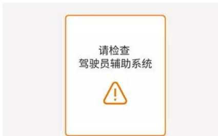
如果车道跟踪辅助(LFA)功能出现故障,仪表盘将显示警告信息持续一段时间,同时主(△)警告灯亮。在此状态下,我们建议您将此系统有关的所有检查、维修和更换工作交由北京现代授权经销商进行。
