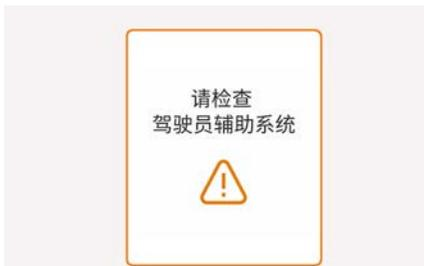
高速公路驾驶辅助 (HDA) 系统不能正常运行时，就会在仪表盘显示器上显示“**请检查驾驶员辅助系统**”的警告信息，并且仪表盘上的黄色车道保持辅助警告灯 (LKA) 亮。在此状态下，我们建议您将此系统有关的所有检查、维修和更换工作交由北京现代授权经销商进行。
