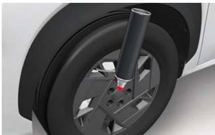
7. 所有密封胶注入完成后，逆时针旋转红色阀门至关闭位置（OFF 方向）。从轮胎充气阀杆上分离填充软管。立即行驶约 10 km，以便对轮胎进行修复和充气。
