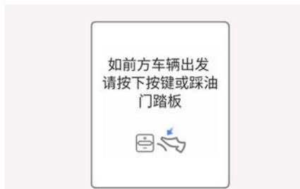
在高速公路驾驶辅助 (HDA) 功能启动状态, 如果前方车辆停车, 本车辆也会停车。同样, 如果在停车后30秒钟内前方车辆起步驶离, 本车辆也起步行驶。此外, 如果车辆停车的时间超过30秒钟, 就会在仪表盘显示器上显示**如前方车辆出发, 请按下按键或踩油门踏板**的警告信息。此时, 踩下加速踏板, 或者向上/向下拨动(+)或(-)开关至增速或减速位置, 或者按下[II]开关起步行驶。
