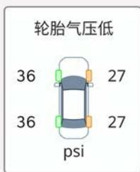
当仪表盘控件上的轮胎气压监测系统 (TPMS) (U) 警告灯亮，并且显示警告信息时，可能您车辆的一个或多个轮胎气压不足。低压轮胎位置指示灯通过点亮对应的指示灯，指示气压明显不足的低压轮胎的位置。
