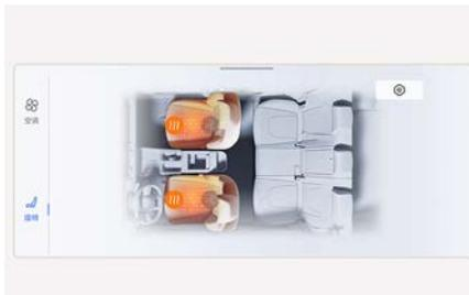
要打开各前座椅加热器，触控信息娱乐系统显示屏上的(🔥)按钮。
