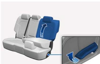
2. 稳固推动座椅靠背，直至发出“咔嚓”声锁定定位。确保座椅靠背牢固锁定在适当位置。
