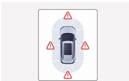
在泊车距离警告 (PDW) 功能控制时，如果此功能不能正常运行，或者超声波传感器被遮挡，就会在仪表盘上对应传感器方向上显示主 (△) 警告灯亮。您可以在仪表盘上的实用视图模式中查看警告信息。
