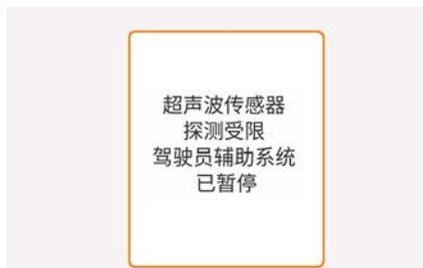
超声波传感器用于检测车辆周围的物体。当超声波传感器被积雪、泥土等异物遮挡时, 会严重影响检测传感器的性能, 这会导致后泊车距离警告 (PDW) 功能暂停或关闭。
