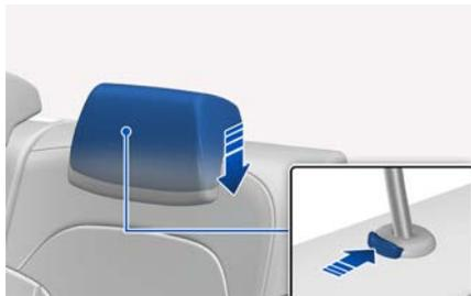
1. 在按住头枕释放按钮的状态，将头枕杆插入至头枕导管孔内。
