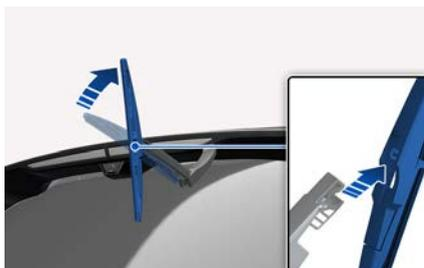
4. 将新品雨刮器片中央部分插入雨刮器臂的槽内，直至听到“咔嗒”声定位。
