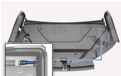
5. 检查拔出的保险丝，如果保险丝熔断，请更换新品。
