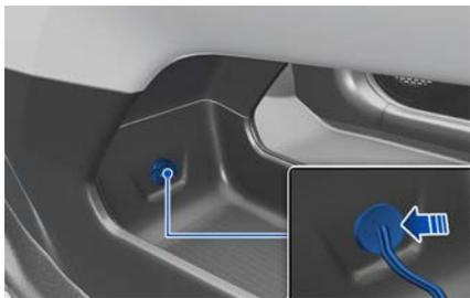
6. 在车辆电源 ON (READY 指示灯 ON) 状态下，接通压缩机电源，运转压缩机约 5~7 分钟，以便填充密封胶，直至达到规定气压（请参考第 2 章“轮胎和车轮”部分）。填充密封胶后，轮胎气压可能会不正确，稍后重新检查和调整。注意，避免充气过度。充气过程中，与轮胎保持一定的安全距离。
