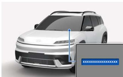
在左侧仪表盘顶部附着板件上也刻有车辆识别码 (VIN)。从车外透过挡风玻璃可轻易看到此板件上的车辆识别码 (VIN)。
