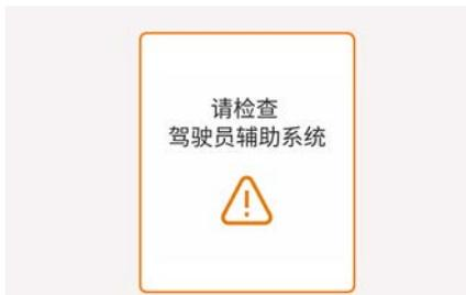
如果巡航控制辅助 (SCC) 功能出现故障，仪表盘将显示警告信息 (一段时间后自动消失)，同时主 (△) 警告灯亮。我们建议您将此系统有关的所有检查、维修和更换工作交由北京现代授权经销商进行。
