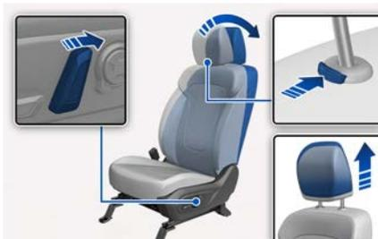
1. 操作座椅靠背调整杆或开关，将座椅靠背向后倾斜。
