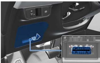
使用北京现代汽车公司授权诊断设备可以从ECU 上读取到车辆识别码 (VIN)。将诊断设备连接在车内保险丝盒上的车载诊断 (OBD) 连接器上。我们建议您向北京现代授权经销商咨询详细信息。
