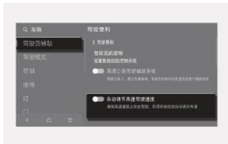
车辆电源在ON位置时，在信息娱乐系统设置菜单中选择或取消选择“设置>车辆>驾驶员辅助>驾驶便利>高速公路自动变速”项，可以设置启用或停用基于导航智能巡航辅助 (NSCC) 功能。
