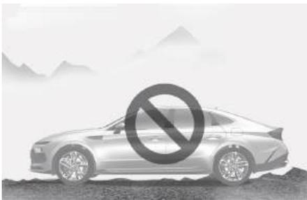
因鹅卵石、碎石等路况条件而车辆打滑或无法移动时，遥控器智能泊车辅助(RSPA)功能可能自动关闭。
