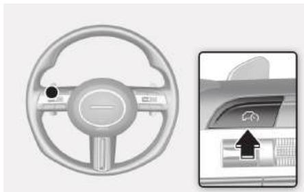
要关闭手动限速辅助 (MSLA) 功能，再次按下驾驶辅助 (Ⓢ) 按钮。仪表盘上的限速指示灯 (LIMIT) 熄灭。
