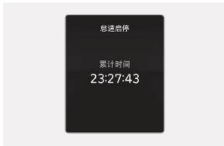
显示发动机在怠速停止& 起动功能控制下自动熄火的累计时间。
