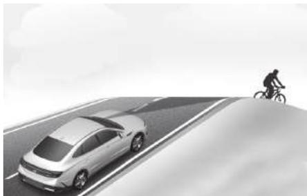
在上坡/下坡道路上行驶时，会严重影响前向防撞辅助(FCA)传感器的检测性能，前向防撞辅助(FCA)功能可能检测不到前方的车辆、动力两轮车、行人或骑行者。
