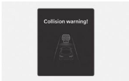
智能巡航辅助 (SCC) 功能启动状态，如果检测到存在与前方车辆发生碰撞的高危险性，就会在仪表盘上显示“注意碰撞”的警告信息，同时发出警报声，向驾驶员发出碰撞危险预警。驾驶车辆时，应始终仔细观察前方路况，并在必要时踩下制动踏板减速，以保持安全车距。
