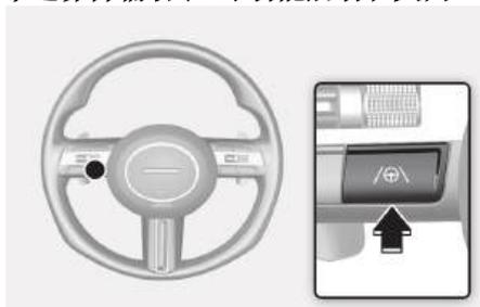
车辆电源在ON位置时，按住方向盘上的车道驾驶辅助(/Ⓢ)按钮，可以启动或关闭车道保持辅助(LKA)功能。当车道保持辅助(LKA)功能启动时，仪表盘上的灰色或绿色车道安全指示灯(/Ⓢ)亮。
