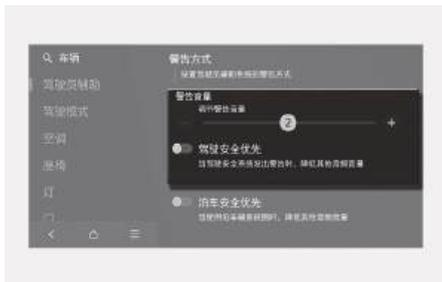
车辆电源在ON位置时，可以设置警告方式。在信息娱乐系统设置菜单中选择“设置>车辆>驾驶员辅助>警告方式”项，可以如下进行设置或变更：
