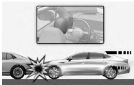
在某些低速碰撞中，气囊可能不展开。气囊设计为在这些情况下不展开。因为在低速碰撞中，安全带能提供足够的保护，而即使气囊展开也不能提供额外保护。
