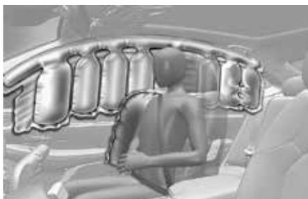
侧气囊和侧气帘设计为，当侧面碰撞传感器检测到碰撞时，根据侧面碰撞的严重程度决定是否展开。
