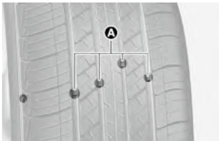
如果轮胎胎面磨损均匀，胎面磨损指示器[A]将作为横过胎面的硬带出现。这表示胎面剩余厚度不足1.6mm(1/16in.)。此时应更换轮胎。
