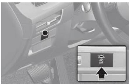
按下怠速停止&起动关闭 (ISG OFF) 按钮时，怠速停止&起动 (ISG) 功能关闭。怠速停止&起动关闭 (ISG OFF) 按钮指示灯亮。要启动怠速停止&起动 (ISG) 功能，再次按下怠速停止&起动关闭 (ISG OFF) 按钮。
