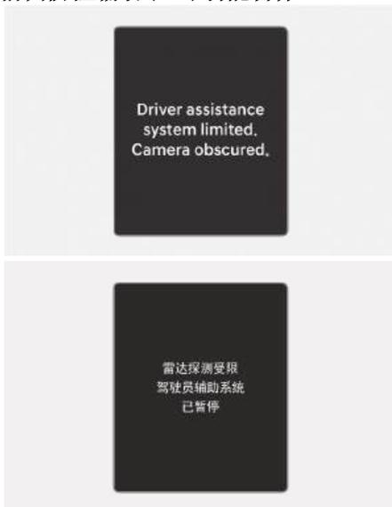
如果前挡风玻璃的前视摄像头安装部位、前雷达传感器盖或传感器被积雪、雨水等异物遮挡,会降低检测传感器的检测性能,这会导致前向防撞辅助(FCA)功能暂停或关闭。
