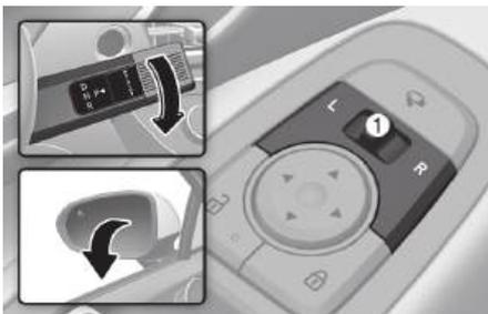
将档位挂入“R(倒车)”档时，外后视镜自动向下偏转，以辅助倒车驾驶。
