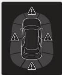
在泊车距离警告 (PDW) 功能控制时，如果此功能不能正常运行，或者超声波传感器被遮挡，就会在仪表盘上对应传感器方向上显示主警告灯 (▲) 亮。您可以在仪表盘上的实用视图模式中看到警告信息。
