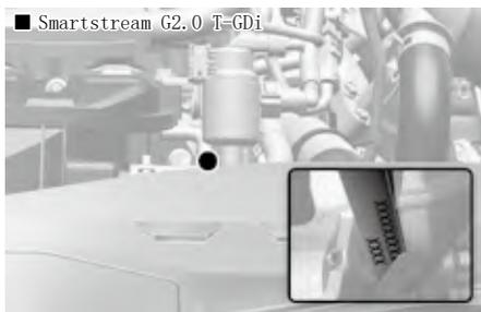
如图所示，发动机号码冲印在发动机缸体上。
