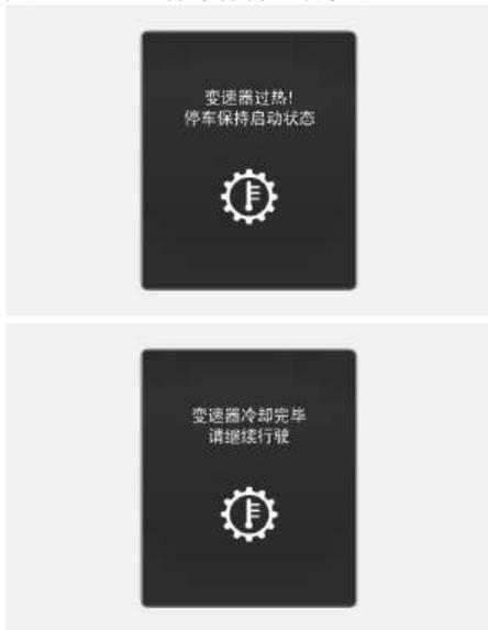
车辆在恶劣的行驶条件(泥泞、沙土路况等)等特殊条件下行驶时，变速器的温度会快速升高，可能最终导致变速器过热。
