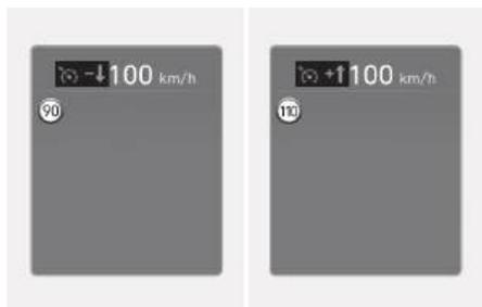
在手动限速辅助 (MSLA) 功能或智能巡航辅助 (SCC) 功能控制期间，当公路设置限速发生改变时，就会以显示向上或向下箭头的方式告知驾驶员需要变更车辆设定限速。此时，驾驶员可以操作方向盘上的增速 (+) 或降速 (-) 开关变更车辆设定限速至与公路设置限速一致。
