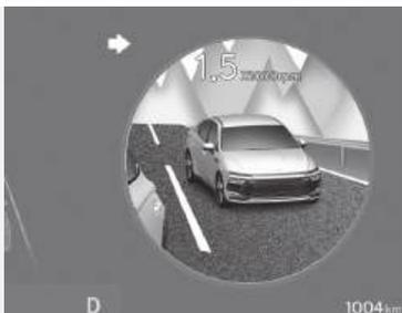
当打开转向信号灯时，盲点影像(BVM)功能使用广角摄像头在仪表盘上显示车辆后侧面盲点的影像，以辅助驾驶员安全变更车道。
