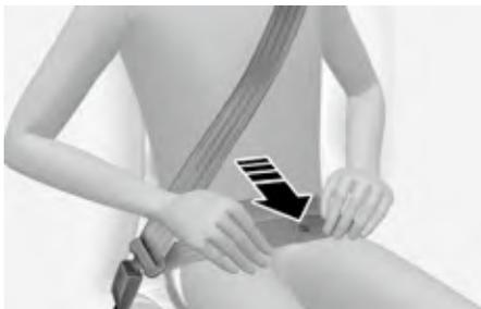
用手调整跨部安全带束带的位置后，将自动调整安全带束带至适合长度，从而能适贴地围绕在您的跨部周围。如果您缓慢轻松前倾，安全带束带会伸出，使您能活动。
