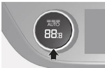
2. 顺时针/逆时针转动温度控制旋钮，设定理想温度。当温度控制设定在最低温度时，制冷系统会持续运行。当车内空气温度达到舒适的程度后，转动温度控制旋钮将温度设定在期望温度。
