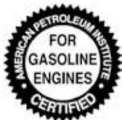
这表示符合国际润滑剂规范咨询委员会(ILSAC)规定的具有美国石油学会(API)认证标志的发动机机油。建议仅使用具有API认证标志的发动机机油。
