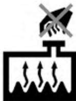
在发动机和散热器热态时，禁止打开发动机散热器盖、冷却液箱盖和拧下冷却液排放螺塞。否则，高温冷却液和蒸汽会在压力作用下喷出，会导致严重人身烫伤。
