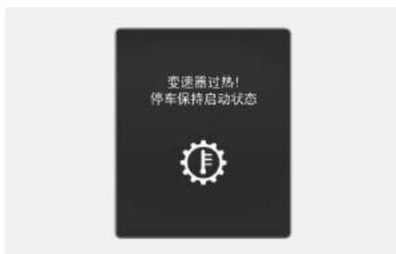
频繁的急加速、紧急起步等驾驶状态，可能导致变速器过热。如果变速器过热，启动自保护模式，就会在仪表盘上显示此警告信息，同时发出警报声，警告驾驶员变速器过热。
