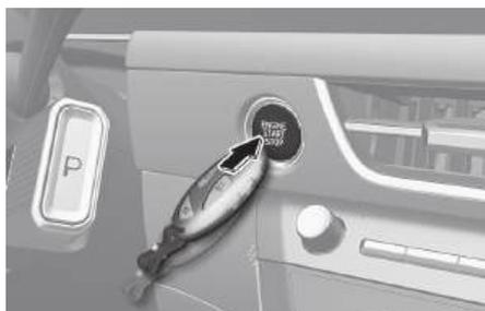
如果智能钥匙电池电量不足或智能钥匙不能正常运行，按照上图所示方向，直接用智能钥匙按下按钮启动点火开关按钮来启动车辆。
