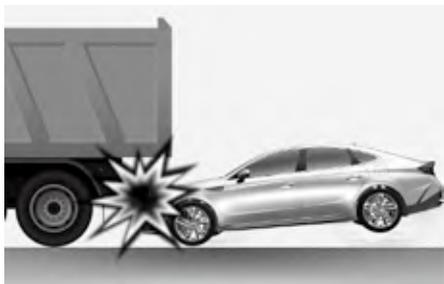
在发生碰撞的一刹那，驾驶员通常会采取紧急制动措施。这种紧急制动有效降低车辆的前部高度，导致车辆的前部“钻撞”。这在前方车辆离地间隙较高时尤其重要。如果车辆处于“钻撞”状态，气囊不会展开，因为传感器检测到的碰撞力会显著减小。
