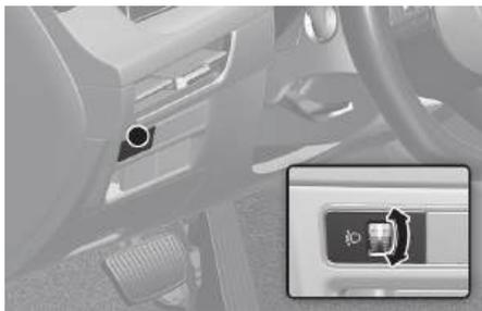
要根据车辆乘员数及行李箱内的装载重量调整大灯光束水平角度，转动大灯水平调整开关至适当等级。
