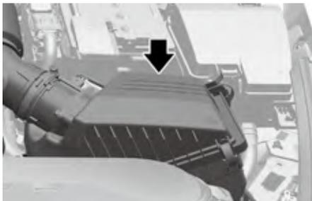
使用压缩空气吹净空气滤清器芯，以便检查。不要用水清洗空气滤清器芯。否则，会导致空气滤清器芯损坏。如果空气滤清器芯很脏，请更换新品。
