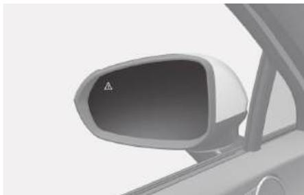
本车辆配备了左侧和右侧外后视镜。可以利用后视镜调整开关远程调整后视镜的位置。可以折叠外后视镜，以防在进入自动洗车机或驶过狭窄的道路时车辆损坏。
