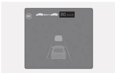
手动限速辅助 (MSLA) 功能或智能巡航辅助 (SCC) 功能根据公路设置限速，辅助车辆调整设定限速。将巡航辅助速度设置为与公路设置限速匹配时，如果公路设置限速改变，车辆自动调整设定限速至与公路设置限速一致。此功能在设置的限速为 100km/h 或以上的公路上行驶时有效。当此功能启动时，仪表盘上的巡航速度指示灯的颜色变为绿色。
