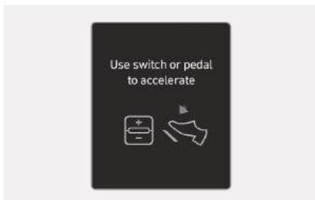
在交通拥堵道路上，如果前方车辆停车，本车辆也停车。同样，如果前方车辆起步驶离，本车辆也起步行驶。此外，如果车辆停车的时间超过一定时间，就会在仪表盘上显示“如前方车辆出发，请按下按键或踩油门踏板”的警告信息。此时，踩下加速踏板，或者向上/向下拨动开关至增速(+)或降速(-)位置，或者按下[II]按钮起步行驶。
