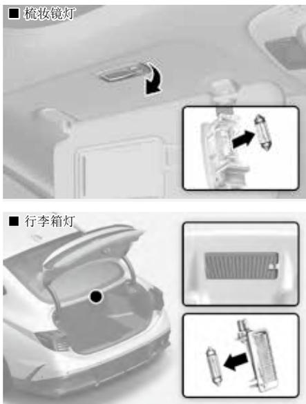
1. 使用一字型螺丝刀从车内灯光总成上轻轻撬下透镜。
