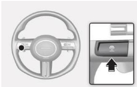
按动车距设置按钮时，车距设置按照“车距4 → 车距3 → 车距2 → 车距1 → 车距4”的顺序改变。
