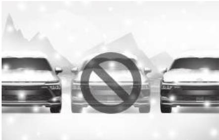
积雪会影响传感器的检测性能，或者因路面光滑而车辆在泊车期间打滑时，遥控器智能泊车辅助(RSPA)功能可能自动关闭。
