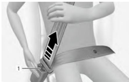
安全带束带会自动收回至卷带器内。如果安全带束带没有自动收回至卷带器内，检查安全带束带是否打结，平顺后重试。
