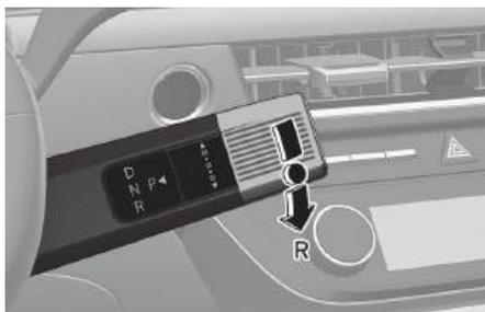
要将档位挂入“R(倒车)”档，在踩下制动踏板的状态下，将换挡旋钮转动至“R(倒车)”档位置。
