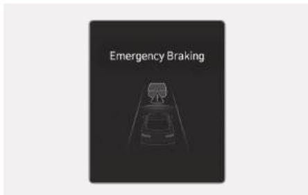
在仪表盘上显示“紧急制动”的警告信息，并且仪表盘上的警告灯(🚨)闪烁，同时发出警报声，向驾驶员发出即将采取紧急制动辅助控制的警报。
