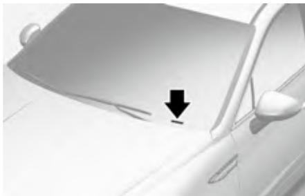
在左侧仪表板顶部附着板件上也刻有车辆识别码 (VIN)。从车外透过挡风玻璃可轻易看到此板件上的车辆识别码 (VIN)。ECU 车辆识别代码信息的工具，型号，购买地点，方式等内容，请参考北京现代维修技术信息网站 ([bhmc.atsw.cn](http://bhmc.atsw.cn))。
