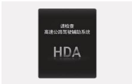
高速公路驾驶辅助(HDA)系统不能正常运行时，就会在仪表盘上显示“请检查驾驶辅助系统”的警告信息，并且仪表盘上的警告灯(△)亮。我们建议您将此系统有关的所有检查、维修和更换工作交由北京现代授权经销商进行。
