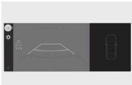
检测到从左后侧面/右后侧面驶近的目标车辆时，外后视镜上的警告灯闪烁，并且在仪表盘上显示警告信息，向驾驶员发出碰撞危险预警。同时发出警报声。如果后视监视器 (RVM) 功能在启动状态，通过信息娱乐系统显示屏也会发出警报。
