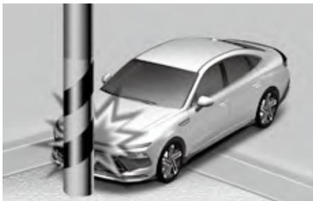
如果车辆与电线杆、树干等物体发生碰撞，在这些碰撞中，碰撞点集中在某个小区域，而且碰撞能量被车辆的结构吸收，因此气囊可能不展开。
