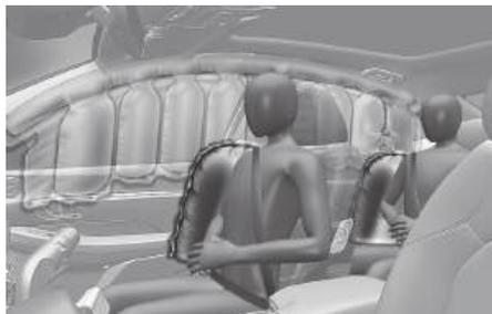
侧气囊设计为，在车辆发生一定程度的侧面碰撞时展开，它们的展开取决于碰撞严重程度。
