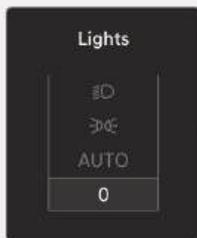
此信息显示利用灯光控制开关控制的外部灯光控制模式。
