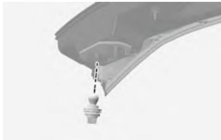
5. 在灯泡插座上按压灯泡并逆时针转动，直至灯泡上的舌片对正灯泡插座上的导槽。将灯泡从灯泡插座上拔出。
