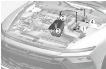
5. 按照上图所示的正确顺序连接跨接线。
