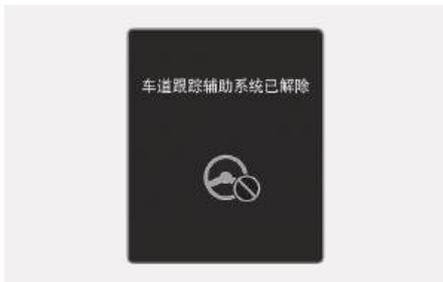
在未握方向盘警告功能发出警报后，如果驾驶员仍然没有握住方向盘，将会显示“车道跟踪辅助已暂停”的警告信息，并且自动关闭车道跟踪辅助(LFA)功能。
