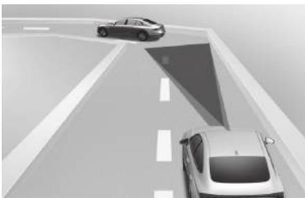
在弯道上行驶时，智能巡航辅助(SCC)功能可能检测不到在相同车道内的前方车辆，这可能会使车辆加速到设定的巡航辅助速度。此外，如果突然检测到前方车辆，车辆可能会紧急减速。
