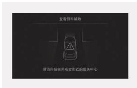
遥控器智能泊车辅助 (RSPA) 系统不能正常运行时，就会在信息娱乐系统显示屏上显示“请检查泊车辅助系统”的警告信息。如果显示此警告信息，停止使用遥控器智能泊车辅助 (RSPA) 功能。我们建议您将此系统有关的所有检查、维修和更换工作交由北京现代授权经销商进行。
