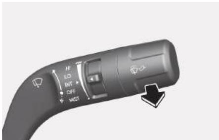
雨刮器&喷水器控制杆在“关闭(OFF)”位置时，向后拉动雨刮器&喷水器控制杆，喷水器启动向挡风玻璃喷射清洗液，同时雨刮器运转1-3周。当雨刮器&喷水器控制杆保持向前推动位置时，后喷水器和雨刮器持续工作，直至释放雨刮器&喷水器控制杆。如果喷水器不工作，可能是挡风玻璃清洗液箱空所致，需要加注挡风玻璃清洗液。
