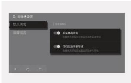
要设置或变更后视监视器(RVM)功能的“显示内容(显示设置)”设置，在后视监视器(RVM)功能运行期间，触摸显示屏上的设置(⚙️)图标键，或者在车辆电源在ON位置时，在信息娱乐系统设置菜单中选择“驾驶员辅助>泊车安全>摄像头设置”项，可以进行设置或变更设置。
