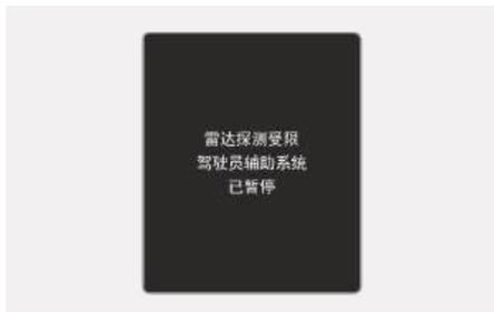
当前雷达传感器盖或传感器被积雪、雨水等异物遮挡时，会降低检测传感器的检测性能，这会导致智能巡航辅助(SCC)功能暂停或关闭。
