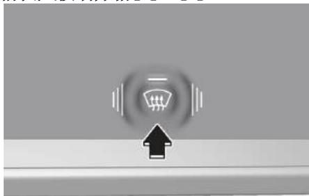
按下前挡风玻璃除霜按钮(指示灯亮)时,前挡风玻璃除霜功能启动。如果设置挡风玻璃除雾模式,根据检测的车外温度,自动选择“空气外循环(新鲜空气)”模式,并且自动启动运行制冷系统。
