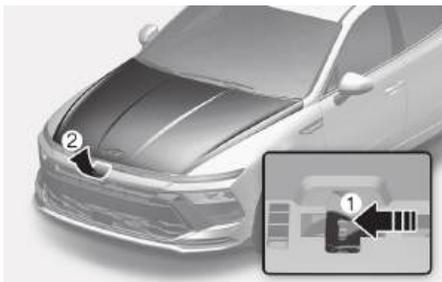
3. 在车辆前方，稍微抬起机舱盖，并推动位于机舱盖中央内侧的副挂钩控制杆(1)，然后抬起打开机舱盖(2)。
