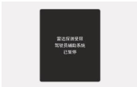
当后侧面雷达传感器或后保险杠的传感器周围被积雪、雨水等异物或安装的挂车、挂架等遮挡时，会降低雷达传感器的检测性能，这会导致安全下车辅助(SEA)功能暂停或关闭。
