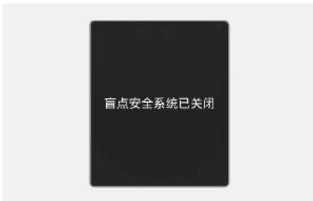
启动车辆时，如果盲点防撞辅助(BCA)功能在“关闭”状态，就会在仪表盘上显示“盲点安全系统已关闭”的警告信息。
