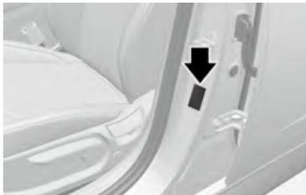
在副驾驶侧中央立柱上的轮胎标签上可以查到轮胎所有规格(轮胎尺寸、气压等)。
