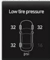
当仪表盘上的轮胎气压监测系统 (TPMS) 警告灯 (⚠️) 亮和显示警告信息时, 可能您车辆的一个或多个轮胎气压不足。低压轮胎位置指示灯通过点亮对应的指示灯, 指示气压明显不足的低压轮胎的位置。
