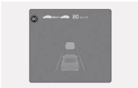
当车速超过显示的限速时，设定限速指示灯的颜色变为红色。
