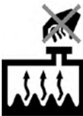
在发动机和散热器热态时，禁止打开发动机散热器盖、冷却液箱盖和拧下冷却液排放螺塞。否则，高温冷却液和蒸汽会在压力作用下喷出，会导致严重人身烫伤。
