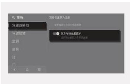
如果启用“前方车辆出发提示”功能，驾驶员注意力提示(DAW)功能在检测到的前方停止的车辆驶离时，向驾驶员发出提示性警报。
