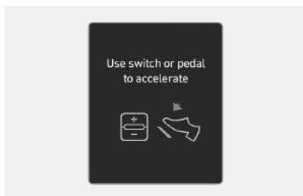
在高速公路驾驶辅助(HDA)功能启动状态，如果前方车辆停车，本车辆也会停车。同样，如果在停车后30秒钟内前方车辆开始移动，本车辆也起步行驶。此外，如果车辆停车的时间超过30秒钟，就会在仪表盘上显示“如前方车辆出发，请按下按钮或踩油门踏板”的警告信息。此时，踩下加速踏板，或者向上/向下拨动开关至增速(+)或降速(-)位置，或者按下[II]按钮起步行驶。
