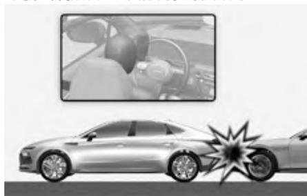
正面气囊设计为在车辆后部发生碰撞时不展开。因为在车辆后部发生碰撞时，在撞击惯性力的作用下，乘员的身体会向后移动。
