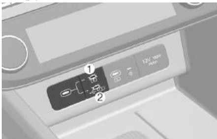
发动机运转时，按下USB接口选择按钮。按下按钮的上部(1)时，可以给电子设备充电。按下按钮的下部(2)时，可以播放多媒体存储设备内的音乐，同时给设备充电。当任何指示灯亮时，可以使用USB接口。
