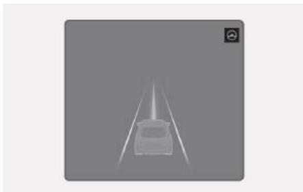
当检测到前方车辆和/或两侧车道线，并且本车车速在200km/h以下时，就会在仪表盘上绿色指示灯(⊕)亮。此时，车道跟踪辅助(LFA)功能通过采取转向辅助控制，辅助驾驶员将车辆保持在本车道中央行驶。
