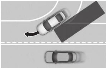
在并道/分岔道口上行驶时，盲点防撞辅助(BCA)功能可能不能正常运行。在此状态下，此功能可能无法检测到相邻车道内的目标车辆。
