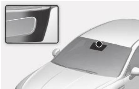
自动除雾功能通过自动检测挡风玻璃内侧的湿气，帮助降低挡风玻璃内侧结雾的可能性。
