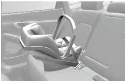
脸朝后儿童保护座椅 (CRS) 由其壳体结构吸收撞击能量，而不是由儿童的身体吸收撞击能量。壳体结构支撑系统摇篮，保护婴幼儿的头部、颈部和脊柱。所有不满1岁的婴幼儿都必须乘坐在脸朝后儿童保护座椅 (CRS) 中。婴幼儿专用儿童保护座椅 (CRS)，仅能使用脸朝后儿童保护座椅 (CRS)；可变换3合1儿童保护座椅 (CRS)，通常在脸朝后位置上有身高和体重限制，以此允许驾驶员长期保持孩子在脸朝后乘坐状态。
