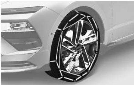
由于子午线轮胎侧围比其它类型的轮胎薄，如果在其上装配某些类型的防滑链，可能会损坏轮胎。因此，请使用推荐的雪地轮胎代替防滑链。如果必须使用轮胎防滑链，请使用北京现代纯正品。安装轮胎防滑链时，仔细阅读随轮胎防滑链提供的使用说明。由于轮胎防滑链使用不当而导致的车辆损坏事件不在新车有限保修范围内。
