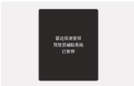
当侧面雷达传感器或后保险杠的传感器装配部位周围被积雪、雨水等异物或安装的挂车、挂架等遮挡时, 会降低雷达传感器的检测性能, 这会导致安全下车警告 (SEW) 功能暂停或关闭。
