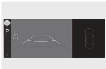
检测到从左后侧面/右后侧面驶近的目标车辆时，外后视镜上的警告灯闪烁，并且在仪表盘上显示警告信息，向驾驶员发出碰撞危险预警。同时发出警报声。在信息娱乐系统显示屏上也会发出警报。
