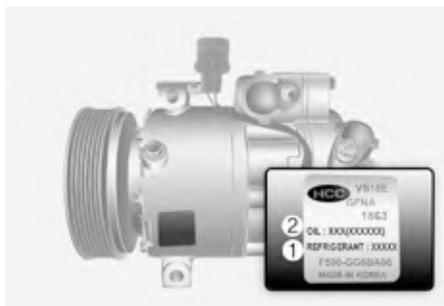
空调压缩机标签上标有您车辆配备的压缩机型号、供应商配件号、生产编号，以及制冷剂 and 压缩机润滑油的规格。
