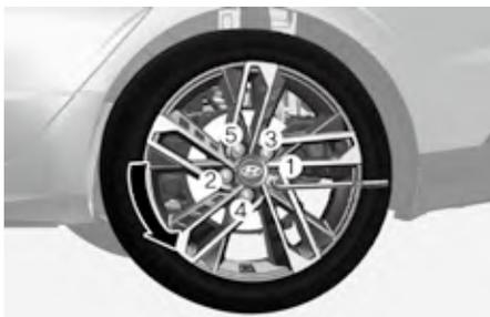
9. 使用车轮螺母扳手进一步拧松所有车轮螺母，然后用手完全拧下。从双头螺栓上拆卸轮毂&轮胎总成，并将其平放在地面上。清除车轮安装表面和备胎上的污染物、杂质。
