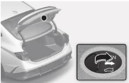
在您车辆的行李箱盖内侧配有紧急行李箱盖安全释放杆。如果有人被意外锁在行李箱内，向箭头方向推动释放杆，然后向上推动打开行李箱盖。
