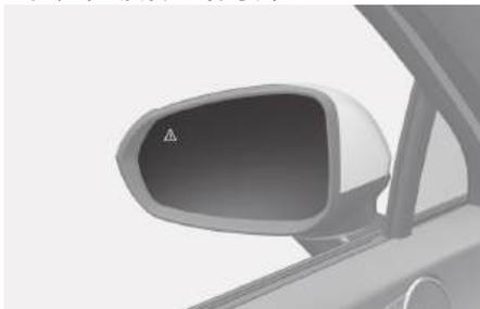
当检测到目标车辆时，外后视镜上的警告灯亮，向驾驶员发出检测到目标车辆的警报。
