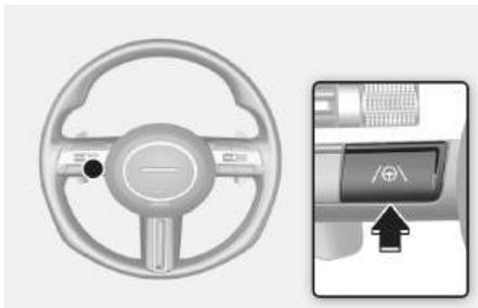
车辆电源在ON位置时，短暂按下方向盘上的车道驾驶辅助(LFA)按钮，车道跟踪辅助(LFA)功能就会启动。仪表盘上的灰色或绿色指示灯亮起。
