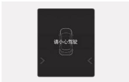
车辆通过此功能采取紧急制动辅助控制而停车时，就会在仪表盘上显示“请小心驾驶”的警告信息。
