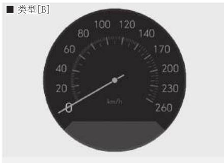
车速表指示车辆的行驶速度。车速表显示标准单位为公里每小时 (km/h)。
