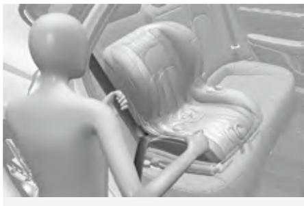
4. 试着推拉儿童保护座椅 (CRS)，确认安全带牢固固定儿童保护座椅 (CRS)。
