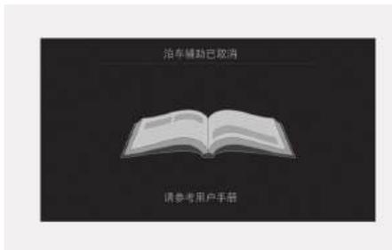
在遥控器智能泊车辅助 (RSPA) 功能操作期间，与泊车顺序无关，均能关闭泊车辅助功能，会在信息娱乐系统显示屏上显示“泊车辅助系统已关闭”的警告信息。根据车辆运行条件，可能会显示其它警告信息。使用遥控器智能泊车辅助 (RSPA) 功能泊车期间，请遵守在信息娱乐系统显示屏上提供的操作指南。在使用遥控器智能泊车辅助 (RSPA) 功能期间，必须始终注意观察车辆周围环境。
