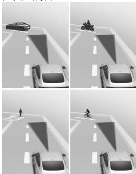
在弯道上行驶时，会严重影响前向防撞辅助(FCA)传感器的检测性能，前向防撞辅助(FCA)功能可能检测不到弯道上前方的车辆、动力两轮车、行人或骑行者。这可能导致在必要时不发出碰撞危险预警、不采取紧急制动辅助控制措施。
