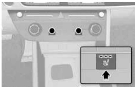
2. 按动座椅加热按钮时，温度控制模式以“高温”、“中温”、“低温”和“关闭”的顺序进行切换。
