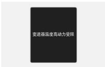
如果在变速器过热的状态继续驾驶车辆，就会在仪表盘上显示此警告信息，并且自我保护模式限制车辆的动力输出。
