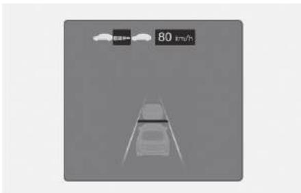
在智能巡航辅助(SCC)功能控制期间，如要临时加速而不改变设定速度，可以踩下加速踏板加速。当踩下加速踏板时，仪表盘上的巡航辅助设定速度、设定车距等级和目标车距将会闪烁。
