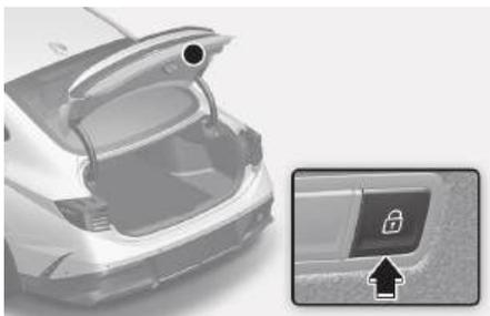
携带智能钥匙，按下电动行李箱盖闭锁按钮。电动行李箱盖自动关闭并闭锁。此外，所有车门同时闭锁。行李箱盖关闭并闭锁，但是所有车门仅在发动机在关闭状态或所有车门在关闭状态时才会闭锁。
