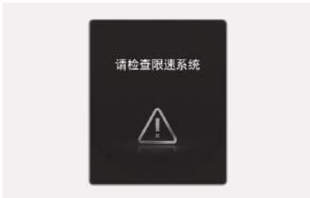
智能限速辅助(ISLA)系统不能正常运行时，就会在仪表盘上显示“请检查限速系统”的警告信息，并且仪表盘上的主警告灯(△)和限速警告灯(⊖)亮。在此状态下，我们建议您将此系统有关的所有检查、维修和更换工作交由北京现代授权经销商进行。
