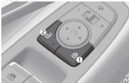
在驾驶位车门扶手上配备有中央控制门锁操纵开关。门锁闭锁按钮以
