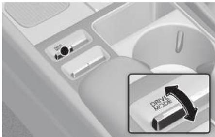
向前/向后拨动驾驶模式 (DRIVE MODE) 开关时，驾驶模式如下进行切换。
