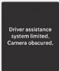
如果前挡风玻璃的前视摄像头安装部位或传感器被积雪、雨水等异物遮挡，会降低检测传感器的检测性能，这会导致车道保持辅助(LKA)功能暂停或关闭。
