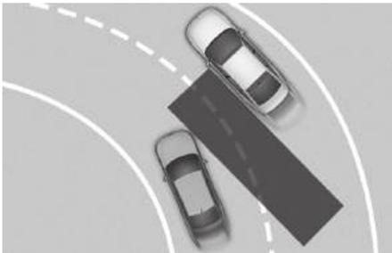
在弯道上行驶时，盲点防撞辅助(BCA)功能可能不能正常运行。在此状态下，此功能可能无法检测到相邻车道内的目标车辆。
