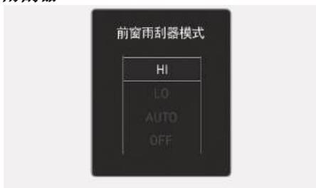
此信息显示利用雨刮器控制开关控制的雨刮器速度控制模式。
