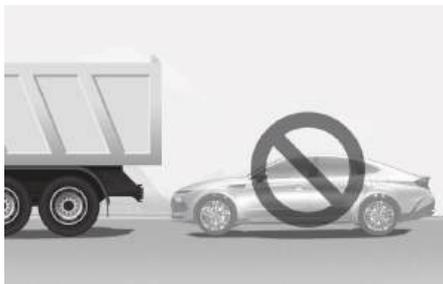
在公共汽车、卡车等离地间隙较高的车辆周围泊车时，禁止使用遥控器智能泊车辅助(RSPA)功能。否则，可能会引发意外事故。
