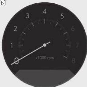
转速表指示发动机每分钟的转数(RPM)。利用转速表显示的转速正确选择换挡点，以免发动机在高速时低速档行驶，而发动机在低速时高速档行驶。
