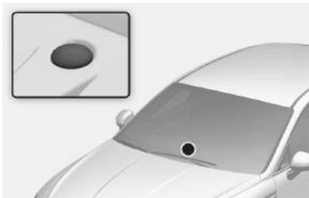
禁止在光照度传感器上和附近加装任何附件，以确保暖风&空调控制系统的最佳性能。
