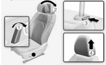
1. 操作座椅靠背调整杆或开关(1)，将座椅靠背向后倾斜(2)。
