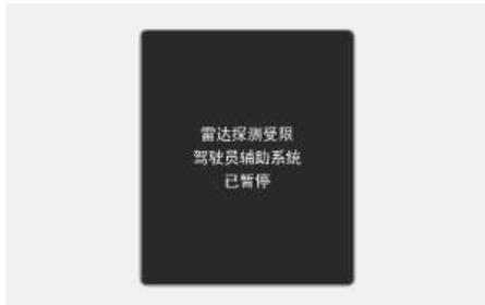
当后侧面雷达传感器或后保险杠的传感器装配部位周围被积雪、雨水等异物或安装的挂车、挂架等遮挡时，会降低雷达传感器的检测性能，这会导致后方交叉防撞辅助(RCCA)功能暂停或关闭。
