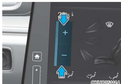
按下屏幕上的温度按钮，设置需要的温度值。点按(+)按钮可以增加温度设置值。点按(-)按钮可以减小温度设置值。
