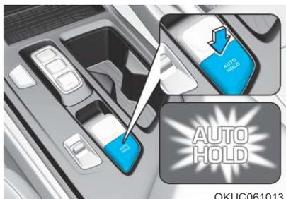
1. 在驾驶席车门、发动机罩和后备箱门（配备换挡按钮的车辆）关闭状态，踩下制动踏板，然后按下自动驻车[AUTO HOLD]开关。白色自动驻车(AUTO HOLD)指示灯亮，系统进入准备就绪位置。
