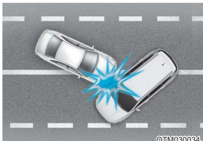
车辆发生角度的碰撞时，在撞击惯性力的作用下，乘员的身体会向气囊不能提供保护的移动，因此传感器可能不展开任何气囊。
