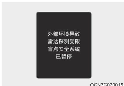
如果后保险杠的后侧方雷达或传感器被杂质覆盖，例如雨雪，或者，如果车辆安装有拖车或托架，则会降低检测性能，暂时限制或禁用安全下车辅助。
