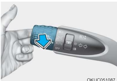
要使大灯远光闪光，可以朝您所在的方向拉灯光控制杆，然后松开灯光控制杆。只要朝自己所在的方向拉动并保持控制杆，则远光一直亮。
