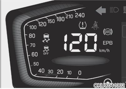
车速表指示车辆的行驶速度，车速表显示标准单位为公里每小时 (km/h)。
