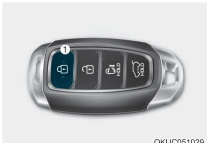
在您通过按下门锁闭锁按钮(1)将发动机关闭后的3秒内，您仍可以控制车窗的移动。在您按下门锁闭锁按钮时，车窗向上移动。在您松开门锁闭锁按钮时，车窗停止移动。车窗完全关闭后，危险警告灯将闪烁3次。
