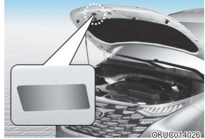
制冷剂标签提供制冷剂类型和用量等信息。
