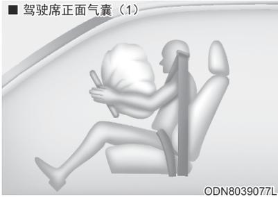
当SRSCM检测到车辆正面碰撞严重性达到一定程度时，自动展开正面气囊。
