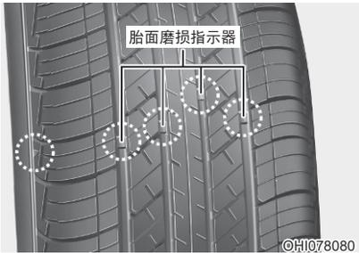
如果轮胎磨损均匀，胎面磨损指示器将作为横过胎面的硬带出现。这表示胎面剩余厚度不足1.6mm(1/16in.)。此时应更换轮胎。
