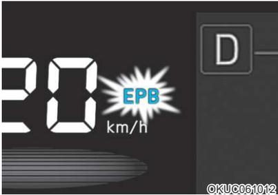
在按下发动机起动/停止按钮置于ON位置时，电动驻车制动(EPB)警告灯亮起，如果系统正常工作，该警告灯在约3秒内熄灭。
