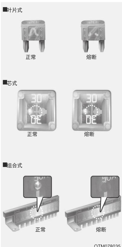
使用保险丝保护车辆的电气系统，避免电气系统电气过载损坏。
