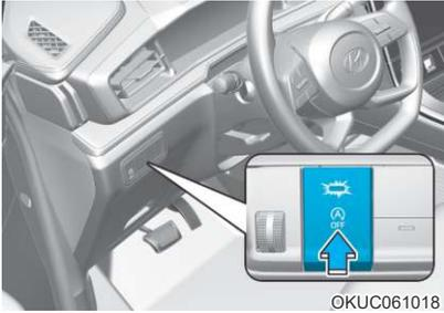
当系统停用时，ISG关闭按钮指示灯会点亮，在组合仪表的LCD显示屏上会出现信息：“自动停止关闭。换挡到P或N，手动起动发动机”，同时伴有报警声音。
