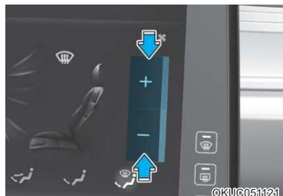
您可以通过在自动空调控制屏幕中点按风扇转速控制按钮，将风扇转速设置为需要的转速值。
