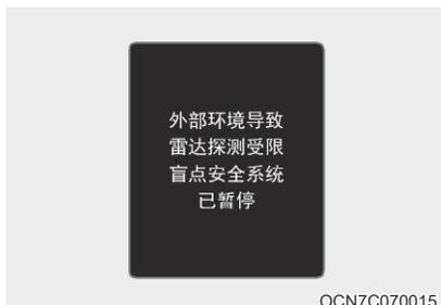
如果后保险杠的后侧方雷达或传感器被杂质覆盖，例如雨雪，或者，如果车辆安装有拖车或托架，则会降低检测性能，暂时限制或禁用安全下车警告。
