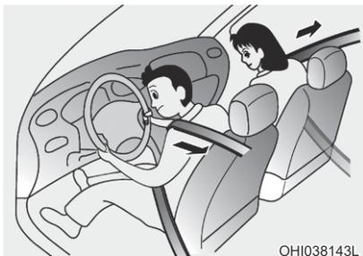
您的车辆为驾驶席和助手席座椅配备有预紧式安全带。配备此拉紧器的目的是为了在发生一定程度的正面碰撞事故时确保安全带紧固乘员的身体。当发生正面碰撞事故，其严重性达到一定程度时安全带拉紧器会与气囊一起工作。
