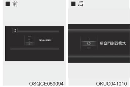
此指示灯利用雨刮器控制，显示选择的雨刮器速度。
