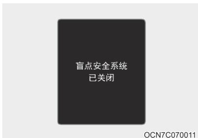
当盲区防止碰撞辅助关闭时，如果发动机重新启动，则在组合仪表上会显示出“盲区安全系统关闭”的信息。
