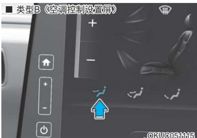
通风模式选择按钮控制从通风系统流出的气流方向。
