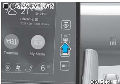
发动机正在运行期间除霜器加热后窗，从而除去后窗内外的霜、雾和薄冰。
