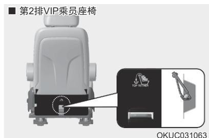
儿童保护座椅顶部固定锚栓位于座椅靠背后面和助手席座椅靠背后面（如有配备）。
