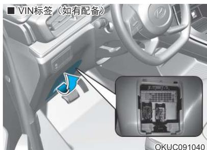
北京现代授权诊断设备可从ECU中找到VIN。诊断设备连接到位于内侧保险盒上的OBD连接器上。有关更多信息，请咨询北京现代授权经销商。
