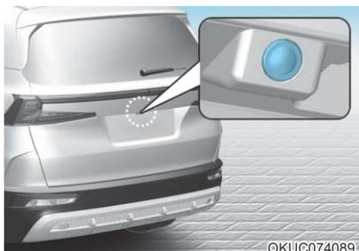
后方显示系统是一个补充系统，该系统将车辆后方影像显示到AVN系统显示屏上，为您提供泊车辅助。
