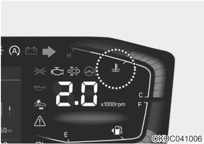
点火开关位于ON（打开）位置时，仪表显示发动机冷却液温度。
