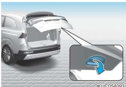
降低后备箱门然后向下按直到后备箱门闭锁。务必在不按下尾门手柄按钮的情况下，试探性向上提起后备箱门进行检查，确定后备箱门牢固固定。
