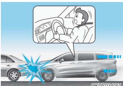
在某些低速碰撞中，气囊会不展开。气囊设计为在这些情况中不展开，因为在低速碰撞中，安全带能提供足够的保护，而气囊不能起到保护作用。
