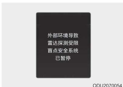
如果后保险杠的后侧方雷达或传感器被杂质覆盖，例如雨雪，或者，如果车辆安装有拖车或托架，则会降低检测性能，暂时限制或禁用后方交叉碰撞警告。
