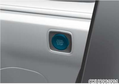
无论何时打开前车门，发动机起动/停止按钮照明灯亮，车门关闭30秒之后照明灯熄灭。
