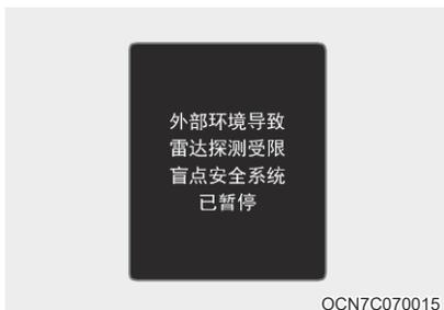
如果后保险杠的后侧方雷达或传感器被杂质覆盖，例如雨雪，或者，如果车辆安装有拖车或托架，则会降低检测性能，暂时限制或禁用盲区防碰撞警告。
