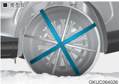
由于子午线轮胎侧围比其它类型的轮胎薄，如果在其上装配某些类型的防滑链，可能会损坏轮胎。因此使用推荐的防滑轮胎代替防滑链。如果必须使用防滑链，使用北京现代正品配件并在审阅防滑链提供的说明书后，安装轮胎防滑链。由于防滑链使用不当而导致的车辆损坏，不属于车辆制造商的保修范围。
