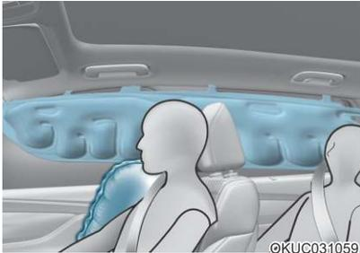
车辆的每个前座椅上都安装了侧面气囊。安装它的目的是给驾驶员和前座乘员提供安全带以外的额外保护。
