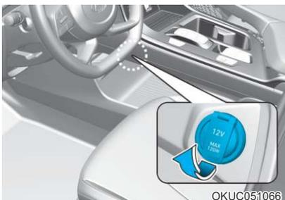
电源插座用于给手机或其它与车上的电气系统一起工作的设备提供电源。发动机运行时，此插座可获得120瓦特以下的电流。
