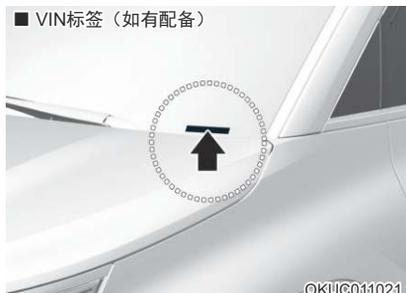
在左侧仪表板顶部附着板件上也有VIN。从外部透过挡风玻璃可轻易看到这个板件上的号码。
