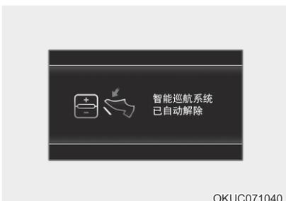
当高速公路驾驶辅助功能工作时，如果前车停下了，则你的车也会停下。另外，如果前车在停止后30秒内又开始运动，则你的车也会开始运动。此外，在车辆停止且过去30秒之后，组合仪表上会显示“使用开关或踏板加速”的信息。踩下加速踏板或推动+开关、-开关或HDA开关开始行驶。
