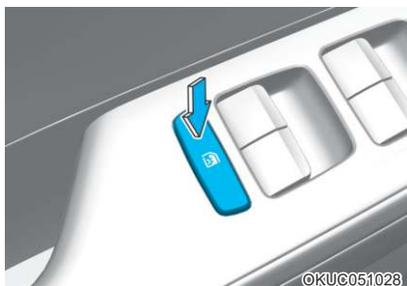
驾驶员可以通过按下电动门窗锁止按钮来停用后乘员车门上的电动门窗开关。
