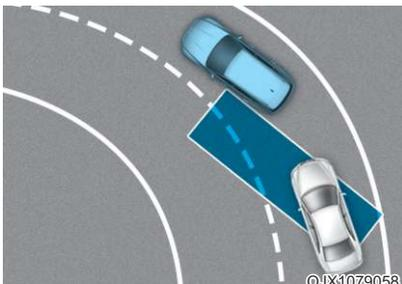
车辆驶过弯道时，盲区防碰撞警告可能不正常工作。系统可能识别到位于同一车道上的车辆。
