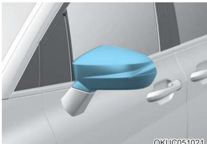
您车辆配备了左侧和右侧室外后视镜。可以使用后视镜调整控制开关远程调整后视镜。室外后视镜可以折叠，有助于在经过自动洗车处或穿过狭窄的街道时防止损坏。
