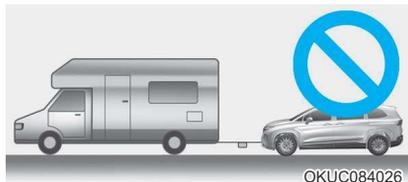
在不使用车轮台车的状态下紧急拖车时：
