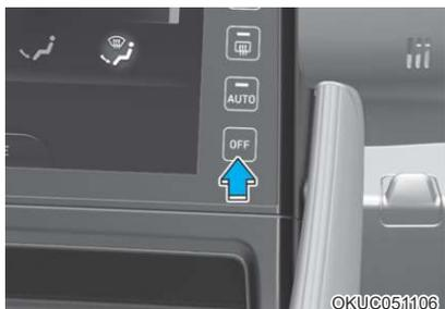
按下OFF按钮即可关闭空调控制系统。只要点火开关位于ON（开启）位置，您就可以继续操作通风模式和内外气选择控制按钮。
