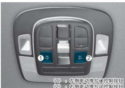
(1)：左侧电动推拉门控制按钮
