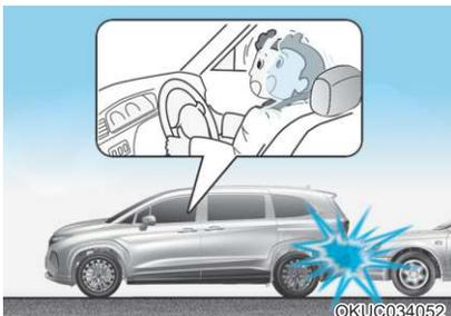
正面气囊设计为在车辆后部发生碰撞时不展开。因为在车辆后部发生碰撞时，在撞击惯性力的作用下，乘员的身体会向后移动，因此即使正面气囊展开也不能提供任何保护。
