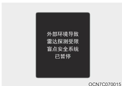
如果后保险杠的后方雷达或传感器被杂质覆盖，例如雨雪，或者，如果车辆安装有拖车或托架，则会降低检测性能，暂时限制或禁用盲区防止碰撞辅助。
