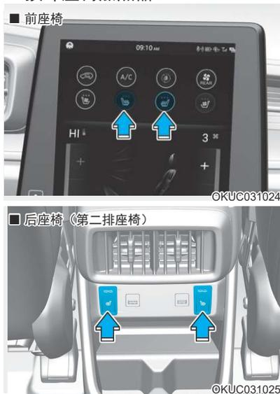
在发动机运行时，按下两个按钮中的一个，对驾驶席座椅或助手席座椅进行加热。
