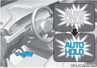
2. 踩下制动踏板完全停车时，自动驻车(AUTO HOLD)维持制动压力，保持车辆静止状态。指示灯颜色由白色变为绿色。
