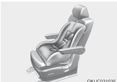
1. 将儿童保护座椅顶部固定带置于座椅靠背上方。请遵守儿童保护座椅制造商的说明放置顶部固定带。
