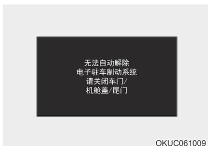
要解除EPB，关闭车门、发动机罩和后备箱门
