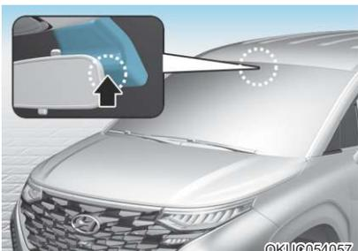
位于挡风玻璃上端的雨量传感器可探测降雨量，并控制刮水循环，使其以合适的间隔运行。
