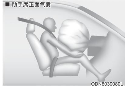
气囊完全展开后立即开始放气，使驾驶员能够维持前方视野并能执行转向或操作其它控制。
