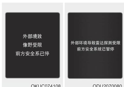
如果安装有前视摄像头的前挡风玻璃、前方雷达有效范围和传感器被杂质覆盖，例如雨雪，则会降低检测性能，暂时限制或禁用前方防止碰撞辅助。
