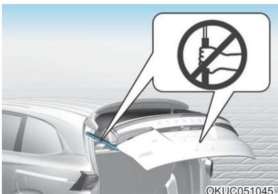
任何时候都不要抓住或抓住后备箱支撑支柱。可能导致后备箱支撑支柱损坏。后备箱支撑支柱的变形可能会导致车辆损坏和人身伤害。
