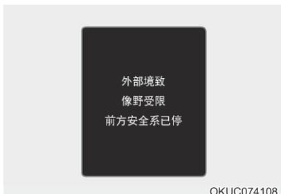
如果安装有前视摄像头的前挡风玻璃和传感器被杂质覆盖，例如雨雪，则会降低检测性能，暂时限制或禁用前方防止碰撞辅助。
