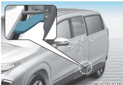
在通过拉门出入车辆时，不要踩拉门铰链，不要使重物跌落到铰链上，也不要再铰链上放置重物。
