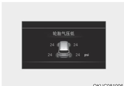
轮胎压力监测系统警告灯亮时，仪表盘LCD显示器上显示一条警告信息，说明您车辆的一个或多个轮胎充气压力明显不足。此低压轮胎位置指示灯通过点亮对应位置指示灯指示充气压力明显过低的轮胎位置。
