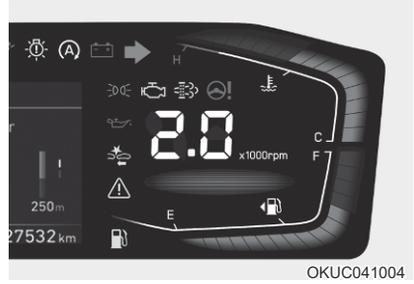
转速表显示发动机转数（转/分，rpm）的近似值。
