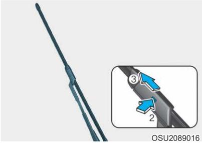
2. 在刮水片略微翘起的情况下(1)，按下雨刮器刮臂(2)上的按钮，滑动刮水片直至拆下(3)。
