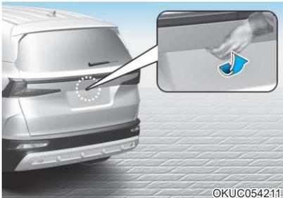
后备箱关闭时，按下电动后备箱打开/关闭按钮以打开后备箱。
