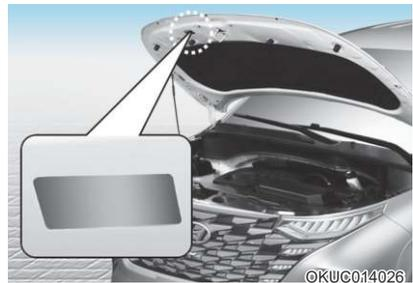
根据车辆生产时您所在国家有效的法规，为您车辆的空调系统加注了R-134a制冷剂。您可以在位于发动机罩内侧的标签上看到哪种空调制冷剂适用于您的车辆。
