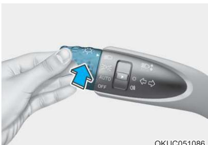
要打开大灯远光，应向远离您的方向推灯光控制杆。操纵杆返回到原始位置。
