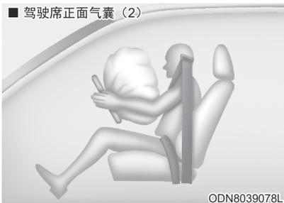
气囊展开时，直接模压在装饰盖内的撕裂接缝会在气囊的膨胀压力作用下被分离。装饰盖进一步打开，气囊膨出完全展开。
