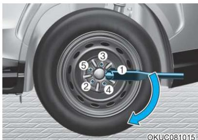
12. 按照上面所示的顺序，使用车轮螺母扳手紧固车轮螺栓。对每个车轮螺栓进行双重检查，确保牢固。更换轮胎后，建议您尽快请北京现代授权经销商将车轮螺栓拧紧到规定力矩。**车轮螺栓应紧固到力矩11~13 kgf.m (79~94 lbf.ft)。**
