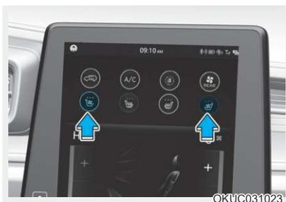
前排和后排座椅上提供有通风式座椅功能，该功能可通过位于座椅座垫或靠背表面的小通风孔来提供通风作用，从而对座椅进行冷却。
