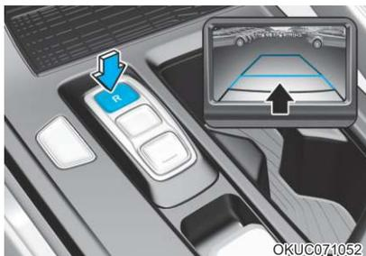
换入R(倒档)时，带泊车引导功能的后方显示系统激活。
