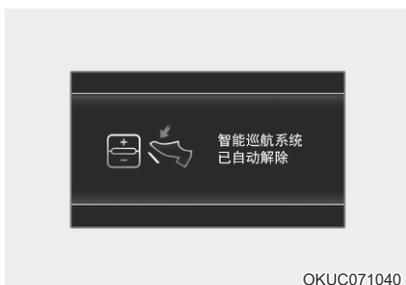
在交通道路上，如果前方车辆停止，您也应停车。同样，如果前车开始移动，您也应驱车起步。此外，在车辆停止且过去一定时间之后，组合仪表上会显示“使用开关或踏板加速”的信息。踩下加速踏板或推动+开关、-开关或
