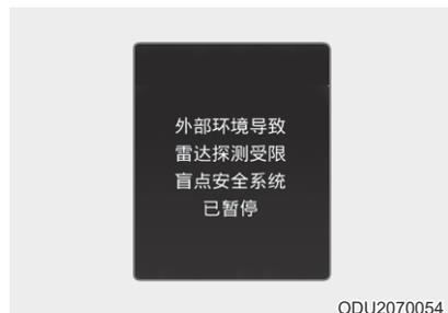
如果后保险杠的后侧方雷达或传感器被杂质覆盖，例如雨雪，或者，如果车辆安装有拖车或托架，则会降低检测性能，暂时限制或禁用后方交叉防止碰撞辅助。
