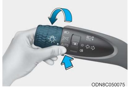
远光灯辅助(HBA)可以根据检测到的车辆亮度和特定道路状况自动调节大灯照明范围（在远光和近光之间切换）。
