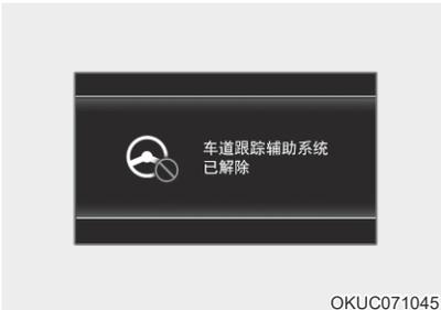
如果在收到“方向盘离手”警告之后，驾驶员仍未将手放到方向盘上，就会出现“车道跟踪辅助(LFA)取消”（或“LFA（车道跟踪辅助）”）的警告信息，同时，车道跟踪辅助会自动取消。
