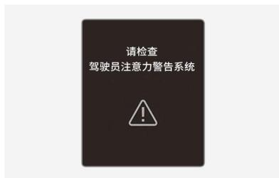
驾驶员注意力提示 (DAW) 系统不能正常运行时，就会在仪表盘上显示“**请检查驾驶员辅助系统**”的警告信息几秒钟，并且仪表盘上的主警告灯 (△) 和驾驶员注意力提示灯 (⚡) 亮。在此状态下，我们建议您将此系统有关的所有检查、维修和更换工作交由北京现代授权经销商进行。
