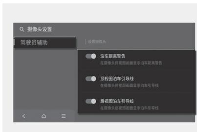
要设置或变更全景影像(SVM)功能的“显示内容”设置，在全景影像(SVM)功能运行期间，触摸显示屏上的设置(⚙️)图标键，或者在发动机运转时，在信息娱乐系统设置菜单中选择“驾驶员辅助 > 泊车安全 > 摄像头设置”项，可以进行设置或变更设置。
