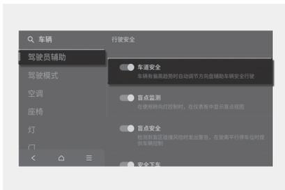
车辆电源在ON位置时,在信息娱乐系统设置菜单中选择“**设置 > 车辆 > 驾驶员辅助 > 驾驶安全 > 车道安全**”项,可以设置启用或停用此功能。
