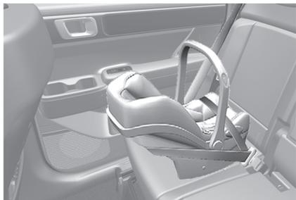
脸朝后儿童保护座椅 (CRS) 由其壳体结构吸收撞击能量，而不是由儿童的身体吸收撞击能量。壳体结构支撑系统摇篮，保护婴幼儿的头部、颈部和脊柱。所有不满1岁的婴幼儿都必须乘坐在脸朝后儿童保护座椅 (CRS) 中。婴幼儿专用儿童保护座椅 (CRS)，仅能使用脸朝后儿童保护座椅 (CRS)；可变换3合1儿童保护座椅 (CRS)，
