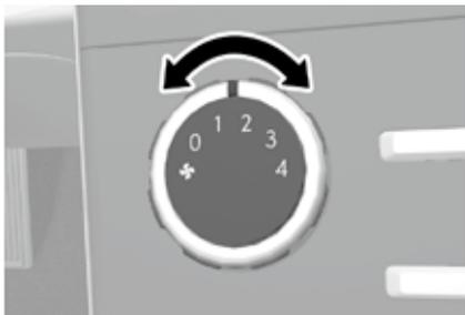
顺时针转动控制旋钮，鼓风机速度增大，送风量增多；逆时针转动控制旋钮，鼓风机速度降低，送风量减少。
