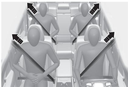
您的车辆在驾驶员侧、副驾驶侧和后乘客座椅上配备了安全带拉紧器(卷带拉紧器)。配备安全带拉紧器的目的是,为了在发生一定程度的正面或侧面碰撞事故时,确保安全带紧固乘员的身体。发生正面或侧面碰撞事故,其严重性达到一定程度时,安全带拉紧器会与气囊一起启动工作。
