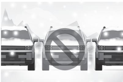
积雪会影响传感器的检测性能，或者因路面光滑而车辆在泊车期间打滑时，**遥控器智能泊车辅助 (RSPA)** 功能可能自动关闭。
