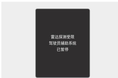
当前雷达传感器盖或传感器被积雪、雨水等异物遮挡时，会降低检测传感器的检测性能，这会导致智能巡航辅助 (SCC) 功能暂停或关闭。
