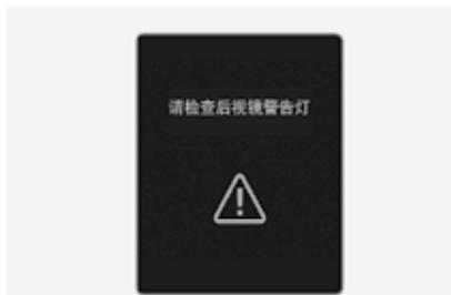
外后视镜上的警告灯不能正常操作时, 就会在仪表盘上显示“**请检查后视镜警告灯**”的警告信息几秒钟, 并且仪表盘上的主警告灯 (△) 亮。在此状态下, 我们建议您将此系统有关的所有检查、维修和更换工作交由北京现代授权经销商进行。
