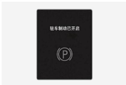
在自动驻车 (AUTO HOLD) 功能控制期间，如果啮合电控驻车制动器 (EPB)，就会发出警报声，并显示此警告信息。
