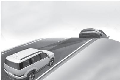
在上坡 / 下坡道路上行驶时，智能巡航辅助 (SCC) 功能可能检测不到本车道内的前方车辆，这可能会使本车辆加速到设定的巡航辅助速度。此外，如果突然检测到前方车辆，车辆可能会紧急减速。
