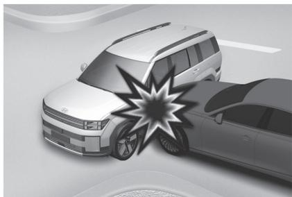
正面气囊设计为在车辆侧面碰撞中不展开。因为在车辆侧面发生碰撞时，由于撞击惯性力的作用，乘员的身体会向碰撞方向移动。
