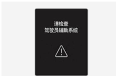
盲点防撞辅助 (BCA) 系统不能正常运行时, 就会在仪表盘上显示“**请检查驾驶员辅助系统**”的警告信息, 并且仪表盘上的主警告灯 (△) 亮。在此状态下, 我们建议您将此系统有关的所有检查、维修和更换工作交由北京现代授权经销商进行。
