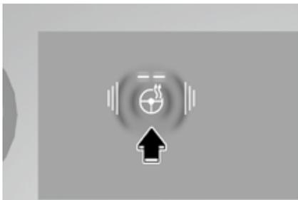
发动机启动/停止按钮在ON位置或发动机运转时，按下方向盘加热按钮，加热方向盘。
