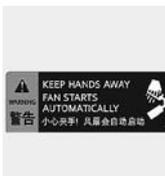
发动机运转期间，将手、衣物和工具等远离转动部件，如冷却风扇、传动皮带等，以免导致人身伤害。
