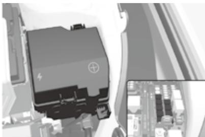
5. 直接拔出可疑保险丝。请使用在发动机舱接线盒内提供的保险丝拔具 (1)。
