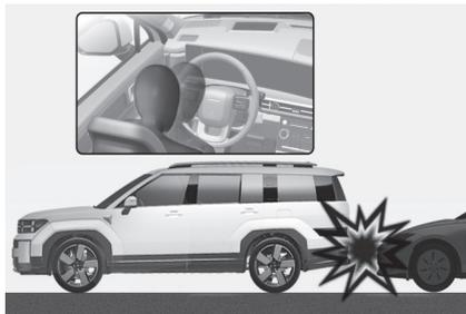
正面气囊设计为在车辆后部发生碰撞时不展开。因为在车辆后部发生碰撞时，在撞击惯性力的作用下，乘员的身体会向后移动。
