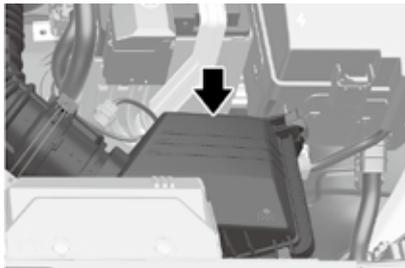
使用压缩空气吹净空气滤清器芯，以便检查。
