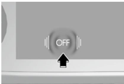
按下系统关闭(OFF)按钮时，暖风&空调控制系统关闭。但是，只要发动机起动/停止按钮在ON位置，仍能操作通风模式按钮和空气内/外循环模式选择按钮。
