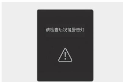
后后视镜上的警告灯不能正常操作时, 就会在仪表盘上显示“**请检查后视镜警告灯**”的警告信息几秒钟, 并且仪表盘上的主警告灯 (△) 亮。在此状态下, 我们建议您将此系统有关的所有检查、维修和更换工作交由北京现代授权经销商进行。
