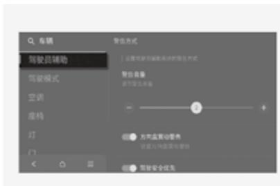
车辆电源在ON位置时，可以设置警告方式。在信息娱乐系统设置菜单中选择“**设置 > 车辆 > 驾驶员辅助 > 警告方式**”项，可以如下进行设置或变更。
