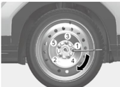
12. 按照如图所示顺序，使用车轮螺栓扳手分几步拧紧车轮螺栓。确认每个车轮螺栓均拧紧。更换轮圈 & 轮胎总成后，我们建议您尽快请北京现代授权经销商按规定扭矩拧紧车轮螺栓。车轮螺栓规定扭矩为 11-13 kgf. m。
