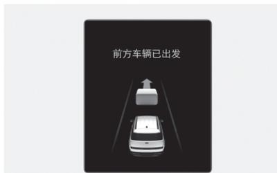
当前方停止的车辆驶离时，前方车辆出发提示功能就会在仪表盘上显示“前方车辆已出发”的提示信息，同时发出警报声，以提醒驾驶员。
