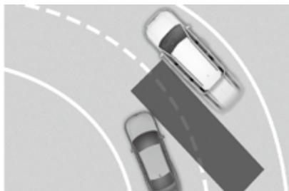
在弯道上行驶时，盲点防撞辅助 (BCA) 功能可能不能正常运行。在此状态下，此功能可能无法检测到相邻车道内的目标车辆。
