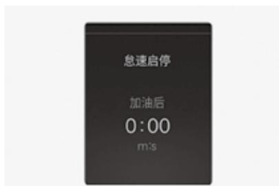
“自动熄火(AUTO STOP)”显示发动机在怠速停止&起动功能控制下自动熄火的累计时间。
