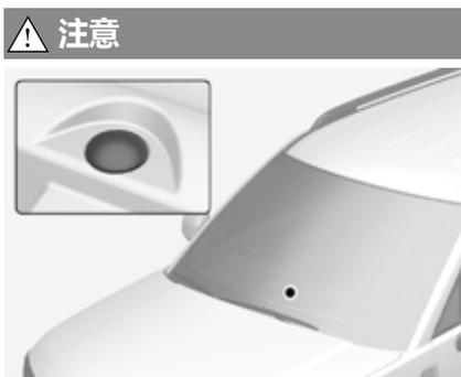
本车辆配备阳光辐射传感器，装配在仪表板的上部。当暖风&空调系统处在“自动控制 (AUTO)”模式时，阳光辐射传感器检测太阳光辐射量，其信号用于车内温度自动控制方面。为了正确的车内温度控制，不要在阳光辐射传感器的上方放置任何物品。
