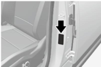
在驾驶位侧中央立柱上的轮胎标签上可以查到轮胎所有规格(轮胎尺寸、气压等)。
