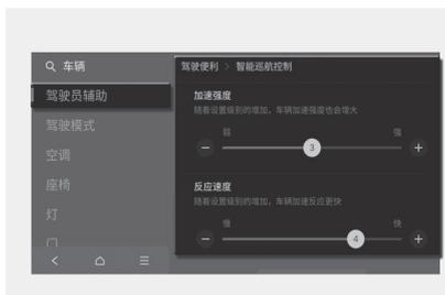
车辆电源在ON位置时，在信息娱乐系统设置菜单中选择“**设置 > 车辆 > 驾驶员辅助 > 驾驶便利 > 智能巡航辅助**”项，可以设置或变更车间距离、加速强度、反应速度等设置。
