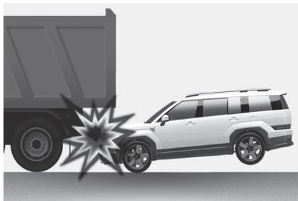
在发生碰撞的一刹那，驾驶员通常会采取紧急制动措施。这种紧急制动有效降低车辆的前部高度，导致车辆的前部“钻撞”。这在前方车辆离地间隙较高时尤其重要。如果车辆处于“钻撞”状态，气囊不
