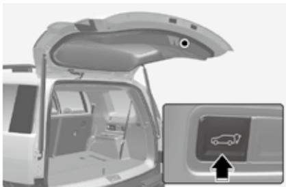
在后备箱门打开状态，按住电动后备箱门打开/关闭按钮，关闭后备箱门。如果在电动后备箱门关闭操作期间释放按钮，电动后备箱门就会停止移动。
