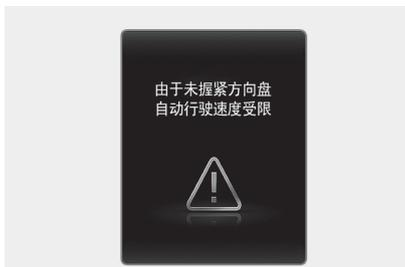
由于未握方向盘警告功能控制关闭高速公路驾驶辅助(HDA)功能时,会启动车速限制功能,限制车速。
