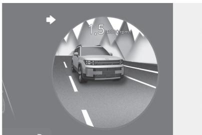
当打开转向信号灯时，盲点影像(BVM)功能使用广角摄像头在仪表盘上显示车辆后侧面盲点的影像，以辅助驾驶员安全变更车道。
