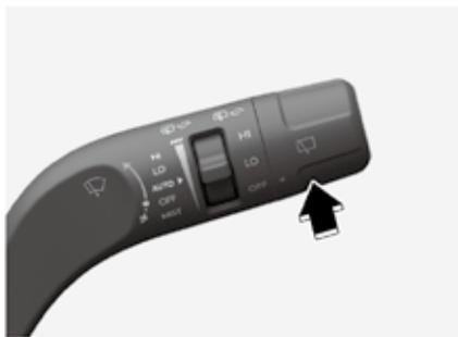
向前推动雨刮器&喷水器控制杆，后喷水器启动向后窗玻璃喷射清洗液，同时后雨刮器运转1-3周。当雨刮器&喷水器控制杆保持在此位置时，喷水器和雨刮器持续工作，直至释放雨刮器&喷水器控制杆。
