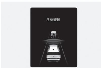
在智能巡航辅助 (SCC) 功能控制状态下，如果检测到存在与前方车辆发生碰撞的高危险性，就会在仪表盘上显示“**注意碰撞**”的警告信息，同时发出警报声和方向盘震动，向驾驶员发出碰撞危险预警。驾驶车辆时，应始终仔细观察前方路况，并在必要时踩下制动踏板减速，以保持安全车距。
