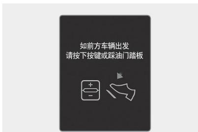
在交通拥堵道路上，如果前方车辆停车，本车辆也停车。同样，如果前方车辆起步驶离，本车辆也起步行驶。此外，如果车辆停车的时间超过规定时间，就会在仪表盘上显示“如前方车辆出发，请按下按键或踩油门踏板”的警告信息。此时，踩下加速踏板，或者向上/向下拨动开关至增速 (+) 或降速 (-) 位置，或者按下 [II○] 按钮起步行驶。
