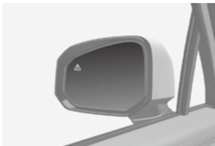
本车辆配备了左侧和右侧外后视镜。可以利用后视镜调整开关远程调整后视镜的位置。请在驾车起步之前，调整好外后视镜位置至理想位置。可以折叠外后视镜，以防在进入自动洗车机或驶过狭窄的道路时车辆损坏。
