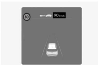
当车速超过显示的限速时，限速指示灯的颜色将变为红色。
