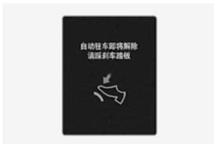
当从自动驻车 (AUTO HOLD) 功能切换至电控驻车制动器 (EPB) 的操作异常时，就会发出警报声，并显示此警告信息。
