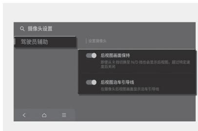
要变更后视镜器 (RVM) 功能的“显示内容”设置，在后视镜器 (RVM) 功能运行期间，触摸显示屏上的设置 (⚙️) 图标键，或者在发动机运转时，在信息娱乐系统**设置**菜单中选择“**驾驶员辅助** > **泊车安全** > **摄像头设置**”项，可以设置或变更设置。
