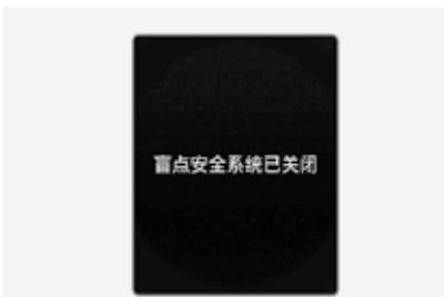
启动车辆时，如果盲点防撞辅助 (BCA) 功能在“关闭”状态，就会在仪表盘上显示“**盲点安全系统已关闭**”的警告信息。
