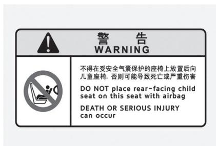
为了警告驾驶员和乘员气囊系统的潜在危险性，在车辆上粘贴有气囊警告标签。
