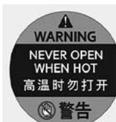
在发动机和散热器热态时，禁止打开发动机散热器盖、冷却液箱盖和拧下冷却液排放螺塞。
