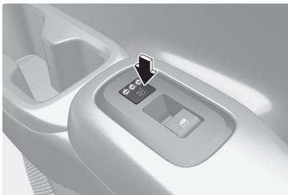
发动机运转期间，操作座椅加热按钮，可以启动座椅加热器加热后座椅。
