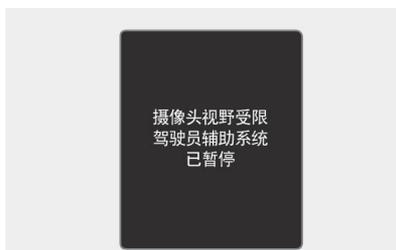
如果前挡风玻璃的前视摄像头安装部位或传感器被积雪、雨水等异物遮挡，会降低检测传感器的检测性能，这会导致驾驶员注意力提示 (DAW) 功能暂停或关闭。在此状态下，就会在仪表盘上显示“摄像头视野受限，驾驶员辅助系统已暂停”的警告信息，并且仪表盘上的主警告灯 (△) 和驾驶员注意力提示灯 (⚡) 亮。当清除积雪、雨水等异物时，驾驶员注意力提示 (DAW) 功能将恢复至正常运行。清除积雪、雨水等异物后，如果驾驶员注意力提示 (DAW) 功能仍然不能正常运行，我们建议您将此系统有关的所有检查、维修和更换工作交由北京现代授权经销商进行。
