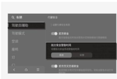
车辆电源在ON位置时，在信息娱乐系统设置菜单中选择“**设置 > 车辆 > 驾驶员辅助 > 驾驶安全 > 前方安全警告时间**”项，可以设置或变更前向防撞辅助 (FCA) 功能的初始警告时间。警告时间可以设置为“**普通**”或“**较慢**”模式之一。
