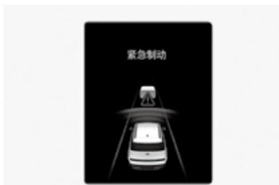
在仪表盘上的前方安全警告灯(🚨)闪烁，并且显示“紧急制动”的警告信息，同时发出警报声和方向盘震动，向驾驶员发出即将采取紧急制动辅助控制的警报。
