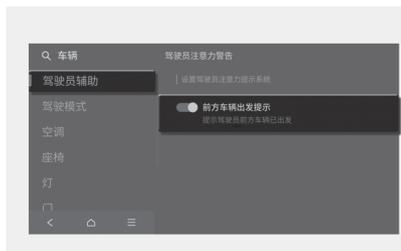
车辆电源在ON位置时，在信息娱乐系统设置菜单中选择“**设置 > 车辆 > 驾驶员辅助 > 驾驶员注意力提示 (DAW)**”项，然后启用“**前方车辆出发提示**”功能，可以使用此功能。
