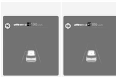
在手动限速辅助 (MSLA) 功能或智能巡航辅助 (SCC) 功能控制期间，当公路设置限速发生改变时，就会以显示向上或向下箭头符号的方式告知驾驶员需要变更车辆设定速度。此时，驾驶员可以操作方向盘上的增速 (+) 或降速 (-) 开关，将车辆设定速度变更至与公路设置限速一致。
