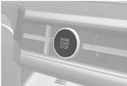
当打开前车门时，发动机起动/停止按钮照明灯亮。当关闭前车门时，照明灯在几秒钟后熄灭。
