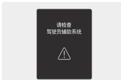
泊车距离警告功能或其它有关功能不能正常运行时，就会在仪表盘上显示“**请检查驾驶员辅助系统**”的警告信息。在此状态下，我们建议您将此系统有关的所有检查、维修和更换工作交由北京现代授权经销商进行。
