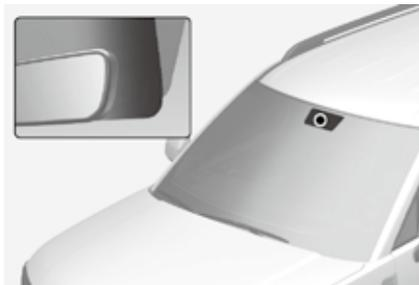
位于挡风玻璃上端的雨量传感器检测降雨量，并以适当的间隔时间控制雨刮器运转周期。
