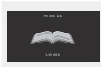
在遥控器智能泊车辅助 (RSPA) 功能操作期间，与泊车顺序无关，均能关闭泊车辅助功能，会在信息娱乐系统显示屏上显示“泊车辅助已取消”的警告信息。根据车辆运行条件，可能会显示其它警告信息。使用遥控器智能泊车辅助 (RSPA) 功能泊车期间，请遵守在信息娱乐系统显示屏上提供的操作指南。在使用遥控器智能泊车辅助 (RSPA) 功能期间，必须始终注意观察车辆周围环境。
