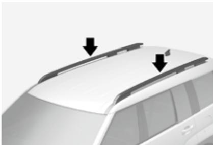
您的车辆可能配备车顶侧行李架。如果您的车辆配备车顶侧行李架，在其上可以加装横梁(没有显示)。
