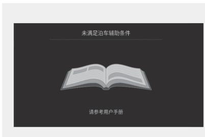
遥控器智能泊车辅助 (RSPA) 功能在待机状态，按住泊车/影像模按钮式 (⏏) 时，会显示“未满足泊车辅助条件”的警告信息。稍后，再次按住泊车/影像模式按钮 (⏏)，检查遥控器智能泊车辅助 (RSPA) 功能是否正常启动。
