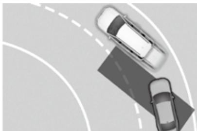
在弯道上行驶时，盲点防撞辅助 (BCA) 功能可能不能正常运行。在此状态下，此功能可能会检测到相同车道内的后方车辆。
