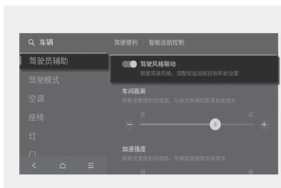
车辆电源在ON位置时，在信息娱乐系统设置菜单中选择“**设置 > 车辆 > 驾驶员辅助 > 驾驶便利 > 智能巡航辅助 > 驾驶风格联动**”项，可以设置启用驾驶风格联动智能巡航辅助(SCC)功能，如“车间距离”、“加速强度”和“反应速度”。
