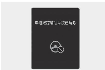
在未握方向盘警告功能发出警报后，如果驾驶员仍然没有握住方向盘，将会显示“**车道跟踪辅助系统已解除**”的警告信息，并且自动关闭车道跟踪辅助(LFA)功能。
