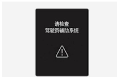
车道保持辅助 (LKA) 系统不能正常运行时, 就会在仪表盘上显示“**请检查驾驶员辅助系统**”的警告信息, 并且仪表盘上的主警告灯 (△) 和黄色车道安全警告灯 (⚠️) 亮。在此状态下, 我们建议您将此系统有关的所有检查、维修和更换工作交由北京现代授权经销商进行。
