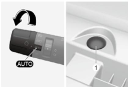
利用位于仪表板上部的自动灯光传感器 (1) 检测的环境亮度信息，自动控制打开和关闭驻车灯/尾灯、大灯。
