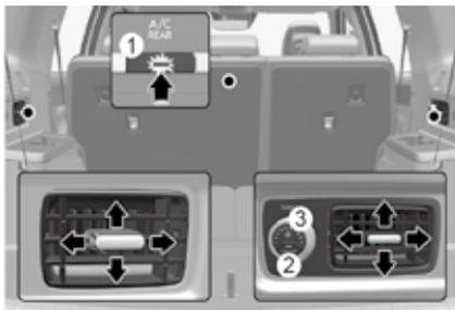
1. 在前暖风 & 空调控制器上，按动前排 / 后排 (FRONT/REAR) 按钮，选择 3 排暖风 & 空调控制模式，然后按动鼓风机速度控制按钮 (2) 调整 3 排鼓风机速度至理想速度 (“REAR” 指示灯亮)。
