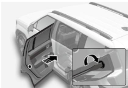
在蓄电池亏电等紧急情况下，唯一的解决方法是利用车门外侧锁筒使用机械钥匙闭锁车门。
