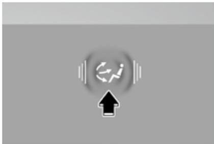
通风模式选择开关控制从通风系统流出的气流方向。
