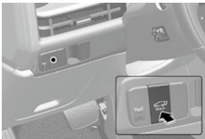
在后备箱门关闭状态下，按住电动后备箱门打开/关闭按钮约1.5秒钟。伴随着警报声，电动后备箱门自动打开。
