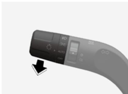
要远光灯闪烁，向后拉动灯光控制杆并释放。如果将灯光控制杆保持在向后拉动位置，远光灯会保持亮，直至释放灯光控制杆。
