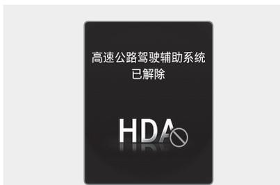
在未握方向盘警告功能发出警报后，如果驾驶员仍然没有握住方向盘，将会显示“**高速公路驾驶辅助系统已解除**”的警告信息，并自动关闭高速公路驾驶辅助(HDA)功能和高速公路变道辅助功能。
