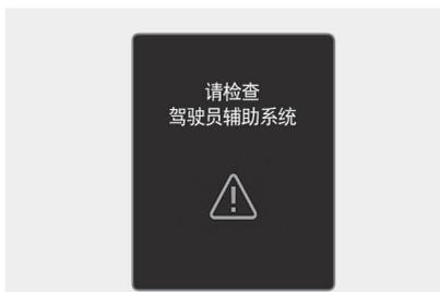
车道跟踪辅助(LFA)系统不能正常运行时，就会在仪表盘上显示“**请检查驾驶员辅助系统**”的警告信息，并且仪表盘上的主警告灯(△)亮。在此状态下，我们建议您将此系统有关的所有检查、维修和更换工作交由北京现代授权经销商进行。
