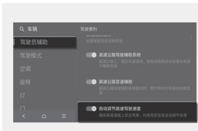
车辆电源在ON位置时，在信息娱乐系统设置菜单中选择“设置 > 车辆 > 驾驶员辅助 > 驾驶便利 > 高速公路自动变速”项，可以设置启用或停用基于导航智能巡航辅助 (NSCC) 功能。
