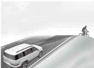
在上坡或下坡道路上行驶时，会严重影响**前向**防撞辅助（FCA）传感器的检测性能，**前向**防撞辅助（FCA）功能可能检测不到前方的车辆、动力两轮车、行人或骑行者。
