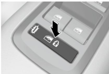
驾驶员通过按下电动门窗锁止按钮可以停用后车门上的电动门窗开关。
