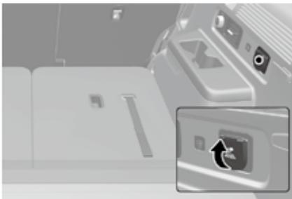
交流逆变器提供220V/200W (或115V/150W) 功率电能，用于使用外部用电器。
