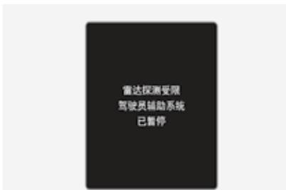
当后侧面雷达传感器或后保险杠的传感器装配部位周围被积雪、雨水等异物或安装的挂车、挂架等遮挡时, 会降低雷达传感器的检测性能, 这会导致盲点防撞辅助 (BCA) 功能暂停或关闭。
