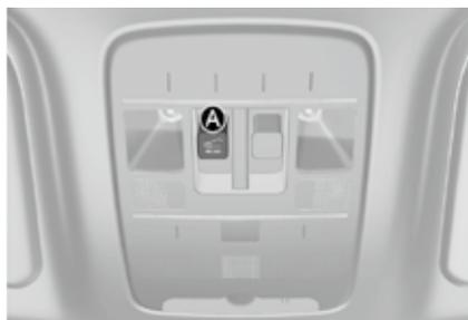
当向后拉动天窗控制杆(A)打开天窗玻璃时，首先遮光板自动打开。但是，在关闭天窗玻璃时，遮光板不会自动关闭。此外，天窗玻璃在打开状态时，不能仅关闭遮光板。
