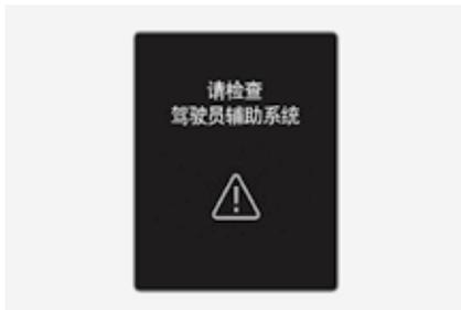
远光灯辅助 (HBA) 系统不能正常运行时, 就会在仪表盘上显示“**请检查驾驶员辅助系统**”的警告信息, 并且仪表盘上的主警告灯 (△) 可能亮。我们建议您将此系统有关的所有检查、维修和更换工作交由北京现代授权经销商进行。
