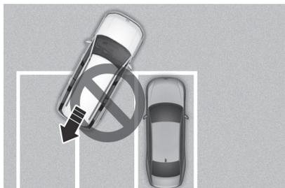
如果使用**遥控器智能泊车辅助 (RSPA)** 功能在仅一侧有已驻车辆的停车位上泊车，本车辆可能为了避开已驻车辆而越过停车位线。
