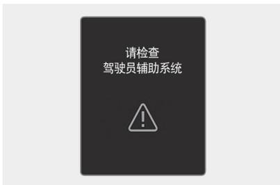
智能限速辅助 (ISLA) 系统不能正常运行时, 就会在仪表盘上显示“请检查驾驶员辅助系统”的警告信息, 并且仪表盘上的主警告灯 (X) 和限速警告灯 (Z) 亮。在此状态下, 我们建议您将此系统有关的所有检查、维修和更换工作交由北京现代授权经销商进行。
