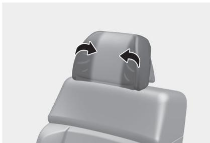
抓住头枕的两侧，并向内侧合拢头枕的两侧。
