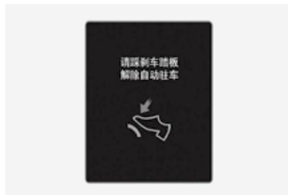
如果在没有踩下制动踏板的状态下，按下自动驻车 (AUTO HOLD) 按钮试图关闭自动驻车 (AUTO HOLD) 功能时，就会发出警报声，并显示此警告信息。
