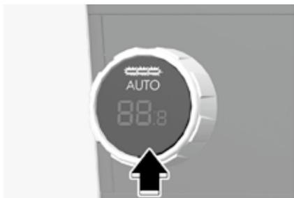
在自动控制模式下，按动“自动控制 (AUTO)”按钮，选择鼓风机速度等级 1 级 ~3 级。
