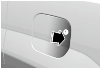
4. 向外拉出燃油加油口门完全打开。
