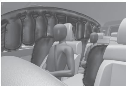
侧气囊、侧气帘和前中央侧气囊设计为，当侧面碰撞传感器检测到碰撞时，根据侧面碰撞的强度决定是否展开。
