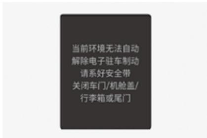
在电控驻车制动器 (EPB) 啮合状态下，如果在没有佩戴驾驶位安全带，或者机舱盖、后备箱门或任何车门没有完全关闭的状态试图驾车起步，就会在仪表盘上显示此警告信息，同时发出警报声。
