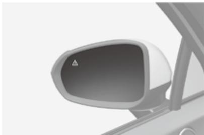
当检测到目标车辆时，外后视镜和平视显示器 (如有配备) 上的警告灯亮，向驾驶员发出检测到目标车辆的警报。
