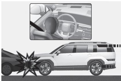
在某些低速碰撞中，气囊可能不展开。气囊设计为在这些情况下不展开。因为在低速碰撞中，安全带能提供足够的保护，而使气囊展开也不能提供额外保护。
