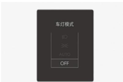
此信息显示利用灯光控制开关控制的外部灯光控制模式。
