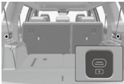
USB 充电接口通过 USB 数据线进行连接，为小型电子设备的电池充电。
