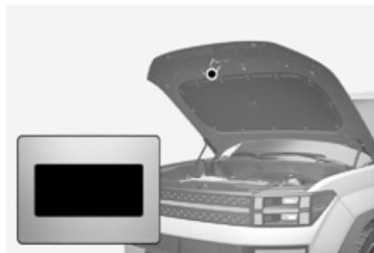
您能从附着在机舱盖内板上的标签上找到您车辆应用的空调制冷剂规格和容量。
