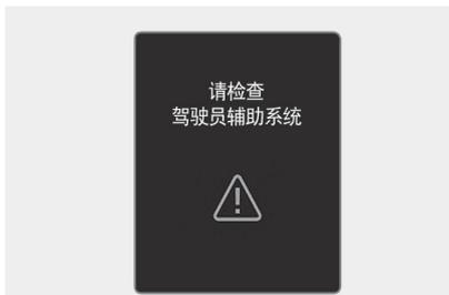
后泊车防撞辅助 (PCA) 系统或其它有关系统不能正常运行时，就会在仪表盘上显示“**请检查驾驶员辅助系统**”的警告信息，并自动关闭后泊车防撞辅助 (PCA) 功能。我们建议您将此系统有关的所有检查、维修和更换工作交由北京现代授权经销商进行。
