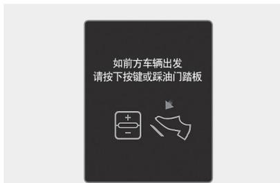
在高速公路驾驶辅助(HDA)功能启动状态，如果前方车辆停车，本车辆也会停车。同样，如果在停车后30秒钟内前方车辆起步驶离，本车辆也起步行驶。此外，如果车辆停车的时间超过30秒钟，就会在仪表盘上显示“**如前方车辆出发，请按下按键或踩油门踏板**”的警告信息。此时，踩下加速踏板，或者向上/向下拨动开关至增速(+)
