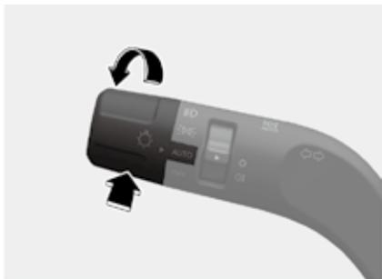
远光灯辅助 (HBA) 功能根据检测到的迎面驶来车辆和前方车辆的灯光亮度, 自动调整大灯模式在远光灯与近光灯之间切换。
