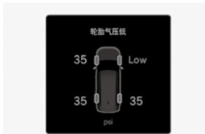
当仪表盘上的轮胎气压监测系统 (TPMS) 警告灯 (⚠️) 亮, 并且显示警告信息时, 可能您车辆的一个或多个轮胎气压不足。低压轮胎位置指示灯通过点亮对应的指示灯, 指示气压明显不足的低压轮胎的位置。
