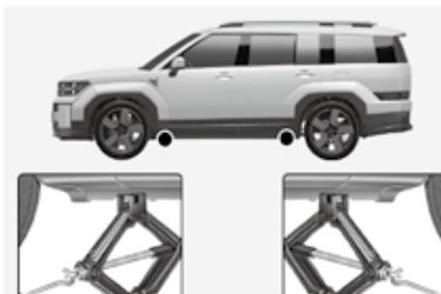
8. 将千斤顶操纵杆插入到千斤顶螺杆环中，并顺时针转动顶起车辆，直至轮胎刚好离地。确定车辆在千斤顶上稳定保持静态。
