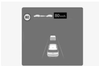
手动限速辅助 (MSLA) 功能或智能巡航辅助 (SCC) 功能根据公路设置限速，辅助车辆调整设定速度。将巡航辅助速度设置为与公路设置限速匹配时，如果公路设置限速改变，车辆自动调整设定速度至与公路设置限速一致。此功能在设置的限速为 100 km/h 或以上的公路上行驶时有效。当此功能启动时，仪表盘上的巡航速度指示灯的颜色变为绿色。
