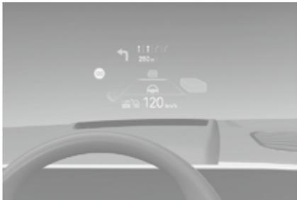
平视显示器(HUD)是选配项目,在车辆行驶过程中,允许驾驶员将视线安全的保持在前方路面上的同时,通过透明显示屏查看到投射在其上的各种信息。
