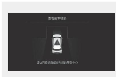
遥控器智能泊车辅助 (RSPA) 系统不能正常运行时，就会在信息娱乐系统显示屏上显示“查看倒车辅助”的警告信息。如果显示此警告信息，停止使用遥控器智能泊车辅助 (RSPA) 功能。我们建议您将此系统有关的所有检查、维修和更换工作交由北京现代授权经销商进行。
