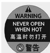
在发动机和散热器热态时，禁止打开发动机散热器盖、冷却液箱盖和拧下冷却液排
