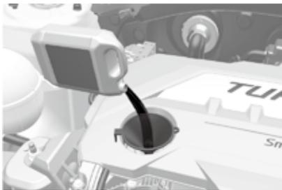
仅能使用规定规格发动机机油(请参考第2章的“推荐油液型号和容量”部分)
