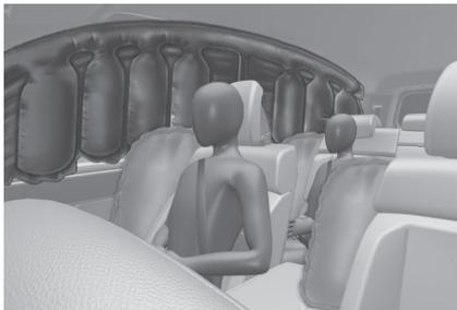
侧气帘位于两侧的前/后车门上方车顶纵梁上。
