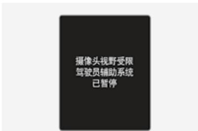
如果前挡风玻璃的前视摄像头安装部位或传感器被积雪、雨水等异物遮挡, 会降低检测传感器的检测性能, 这会导致车道保持辅助 (LKA) 功能暂停或关闭。
