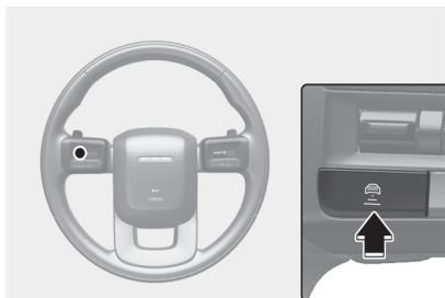
按动车距设置按钮时，车距设置按照“车距4 > 车距3 > 车距2 > 车距1 > 车距4”的顺序改变。
