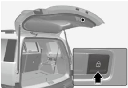
在携带智能钥匙状态下，按下电动后备箱门闭锁按钮。电动后备箱门自动关闭并闭锁。此外，所有车门同时闭锁。
