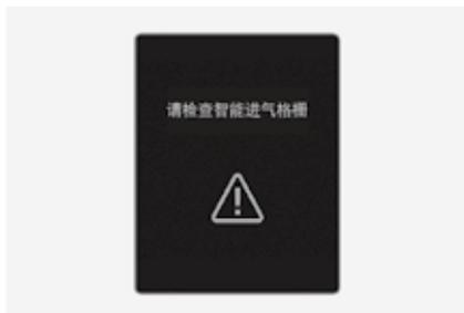
如果由于外部因素或控制器被积雪、雨水等异物污染而导致风门暂时开启,主动风门(AAF)系统可能无法正常运行。
