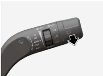
雨刮器&喷水器控制杆在“关闭(OFF)”位置时，向后拉动雨刮器&喷水器控制杆，喷水器启动向挡风玻璃喷射清洗液，同时雨刮器运转1-3周。当雨刮器&喷水器控制杆保持在此位置时，喷水器和雨刮器持续工作，直至释放雨刮器&喷水器控制杆。如果喷水器不工作，可能是挡风玻璃清洗液箱空所致，需要加注挡风玻璃清洗液。
