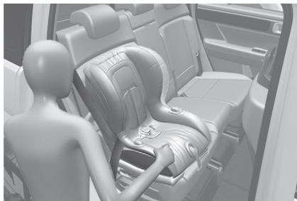
如果儿童保护座椅制造商指导或建议顶部拴带和肩部/胯部安全带配合使用，详细信息请参考“”部分。儿童保护座椅 (CRS) 安装
