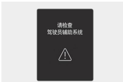
高速公路驾驶辅助 (HDA) 系统不能正常运行时, 就会在仪表盘上显示“请检查驾驶员辅助系统”的警告信息, 并且仪表盘上的黄色车道保持辅助警告灯 (LKA) 亮。在此状态下, 我们建议您将此系统有关的所有检查、维修和更换工作交由北京现代授权经销商进行。
